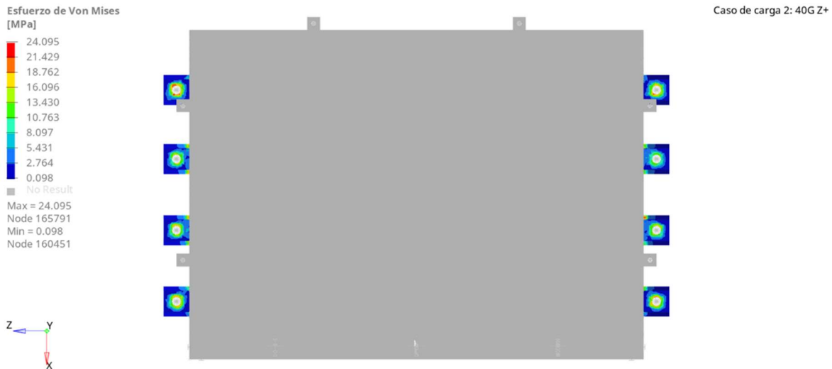
Figura 4.39 Resultado esfuerzo de von Mises sujeciones inferiores 40 G Z+
