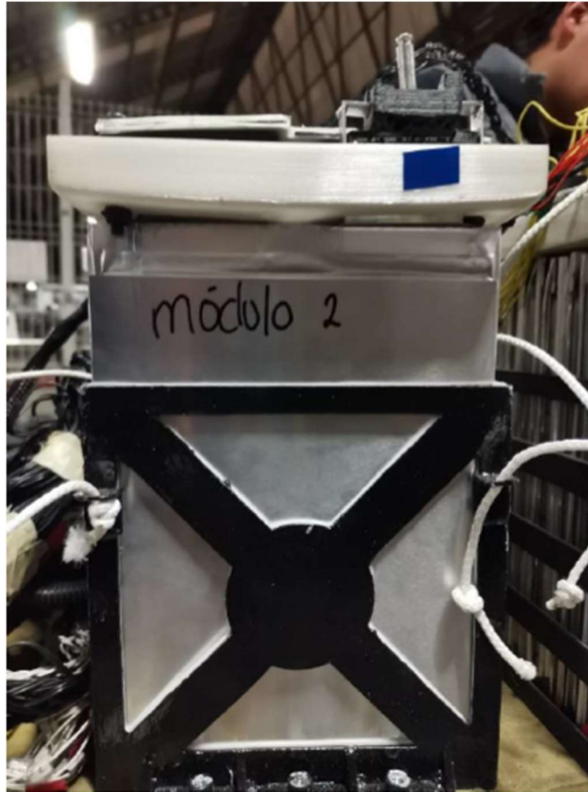
Figura 1.9. Módulo 2 de celdas diseño UM-E3 2020. (UNAM Motorsports, 2020)
