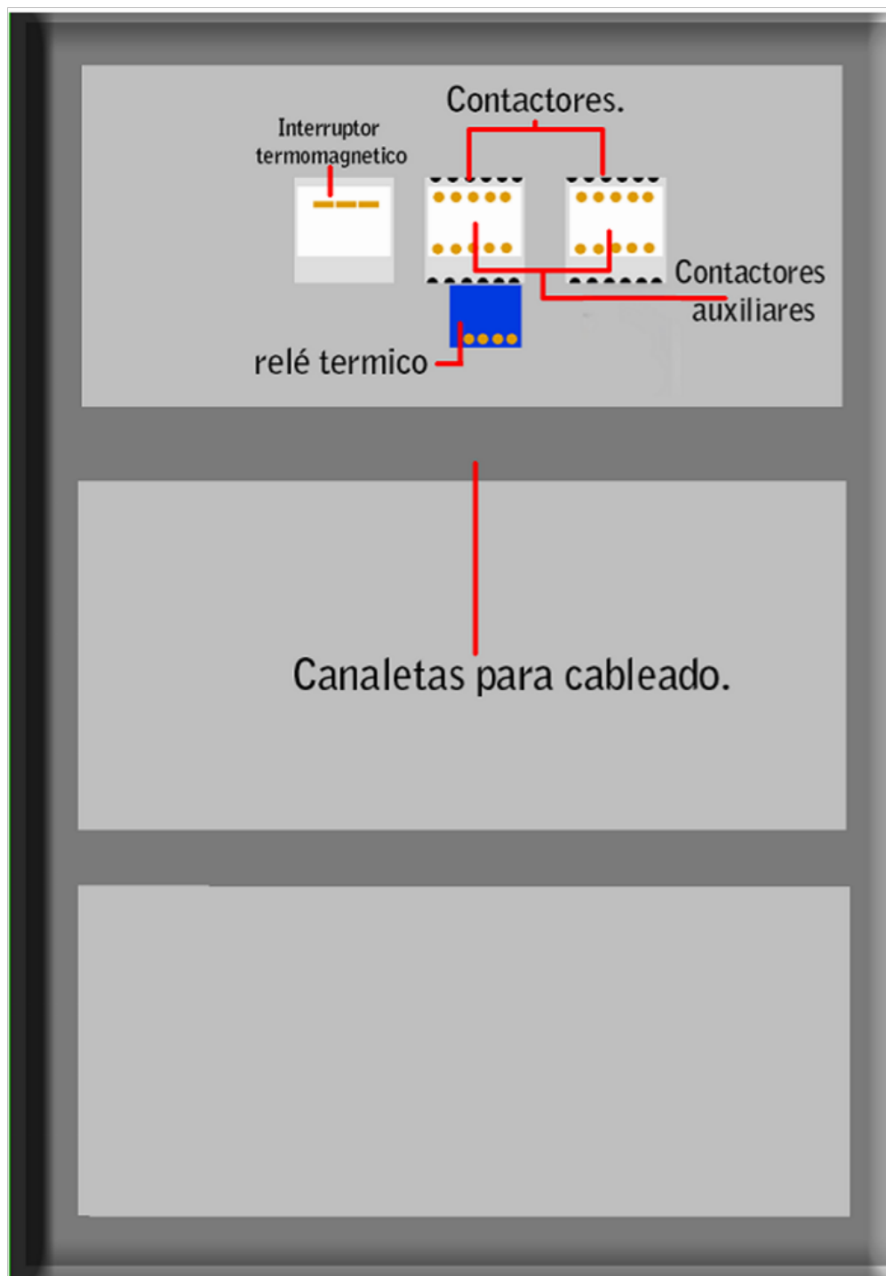
Figura 7.14: Tabla que contiene la nomenclatura mostrada en el plano de control y fuerza del sistema automatizado.
