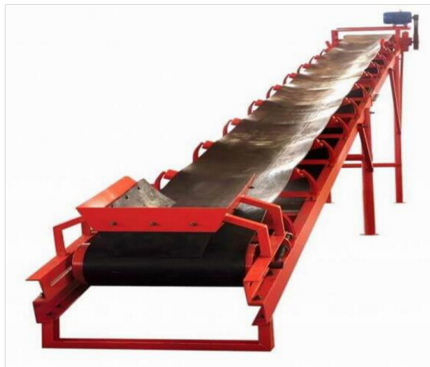
Figura 3.2: Banda de transporte para manejo de materiales de extracción (Metalúrgica) . [2]
