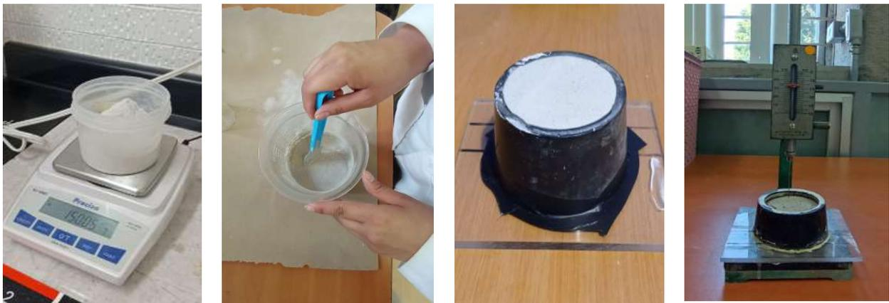
**Figura 28.** Determinación del tiempo inicial de fraguado.
