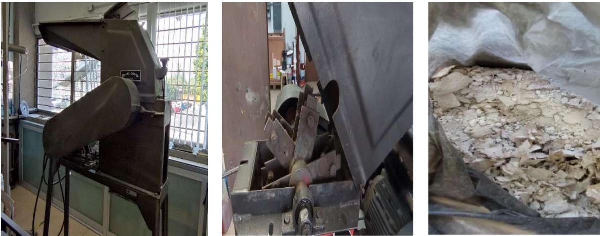
**Figura 20.** Molino de martillos marca Servex modelo P205 (3000 a 3400 rpm).
