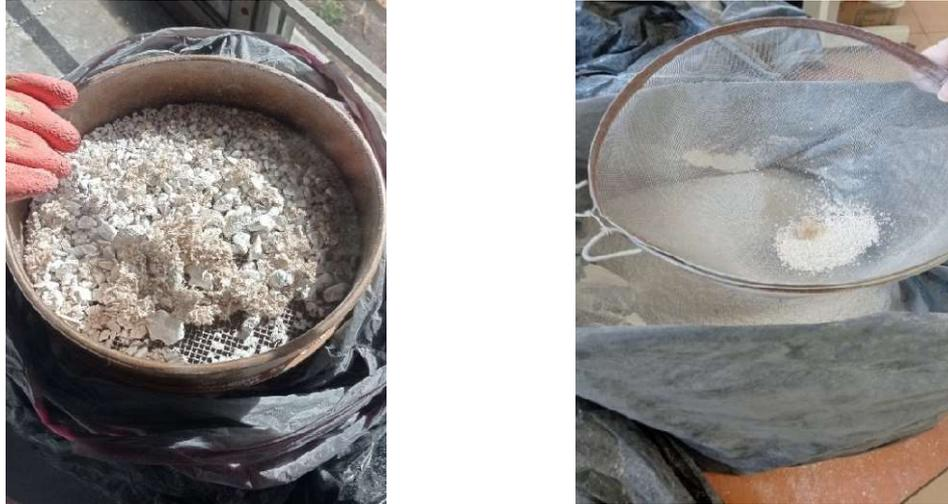
**Figura 22.** Tamizado malla 2.36 mm (izquierda) y tamizado malla 1.4 mm (derecha).
