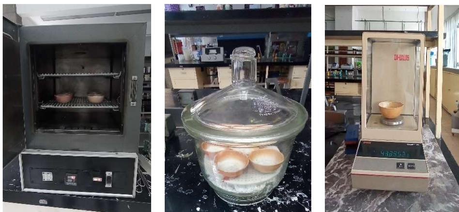
**Figura 25.** Determinación del contenido de humedad.
