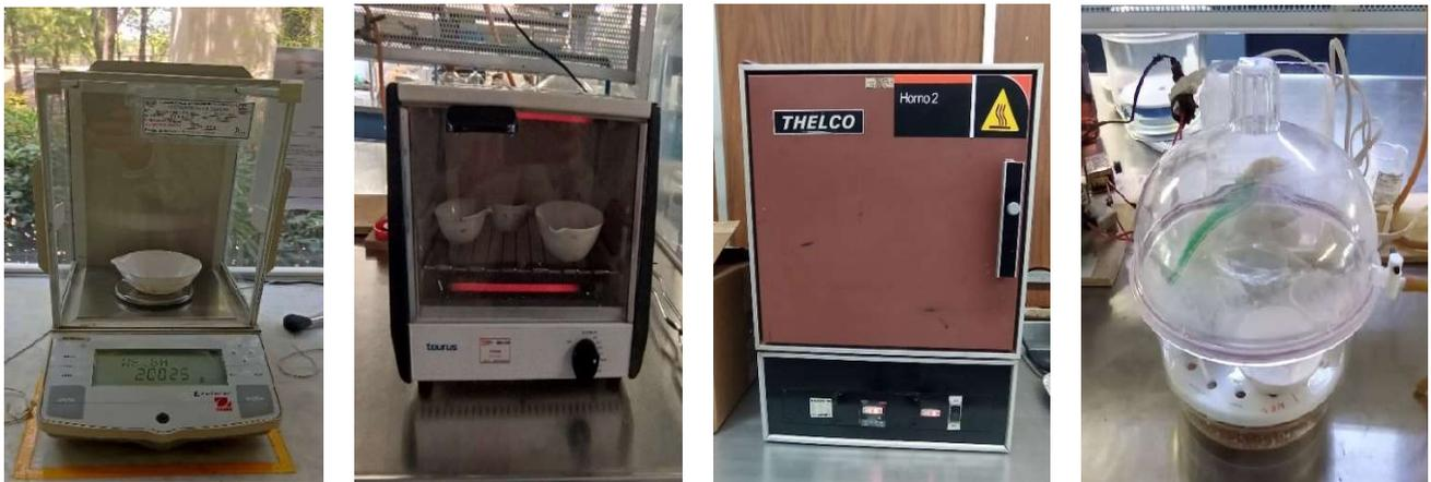
**Figura 26.** Materiales utilizados para la determinación del contenido orgánico.
