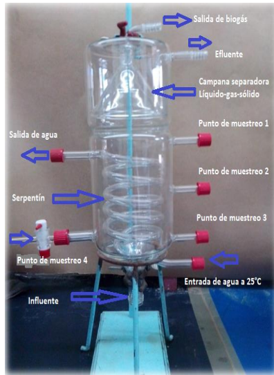
Figura 3.1. Reactor tipo RALLFA (Poblete-Mier, 2015)
