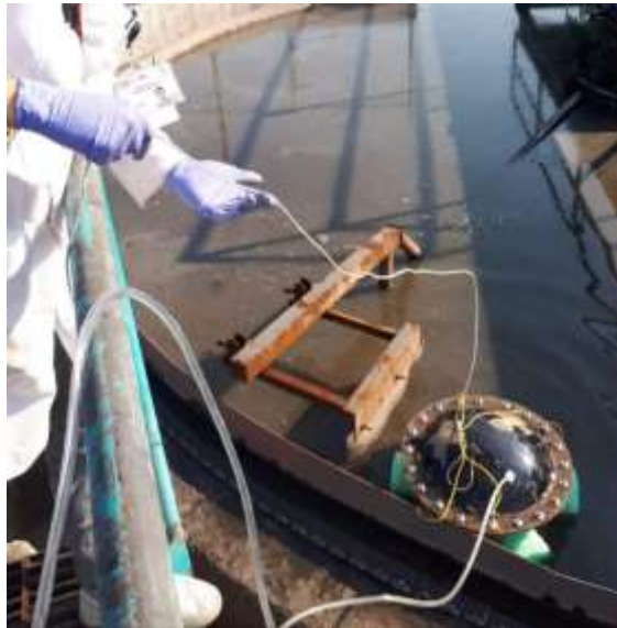
Figura 4.3 Ubicación de la cámara estática dentro del sedimentador. Se muestra el tubo flexible para tomar la muestra con el equipo Biogás 5000.
