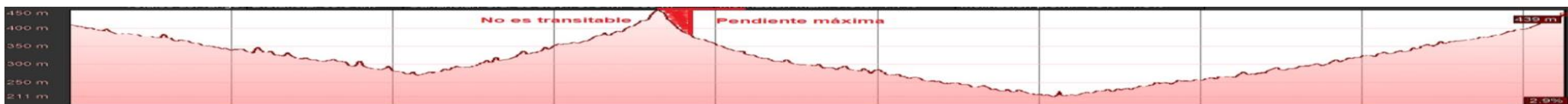
Figura 16. Perfil de elevación del segundo tramo con una distancia de 14.3 km, con una pendiente máxima intransitable de 54.9%. Escala longitudinal de 1 a 800. Escala altitud 1 a 120.
