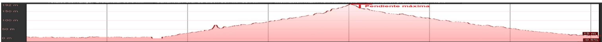
Figura 10. Perfil de elevación Loreto – San Bruno, con una pendiente máxima de 13.7%. Escala longitudinal de 1 a 1,800. Escala altitud 1 a 120.
