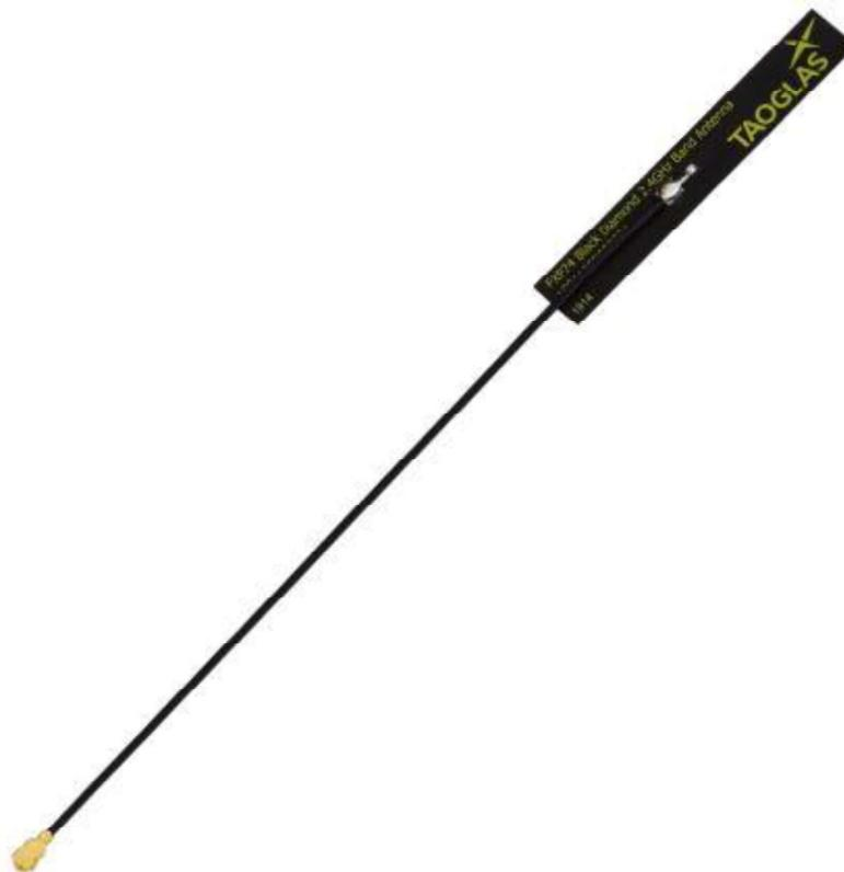
**Figura 31: Antena FXP74, obtenida de las especificaciones de la antena, página 1[30]**
