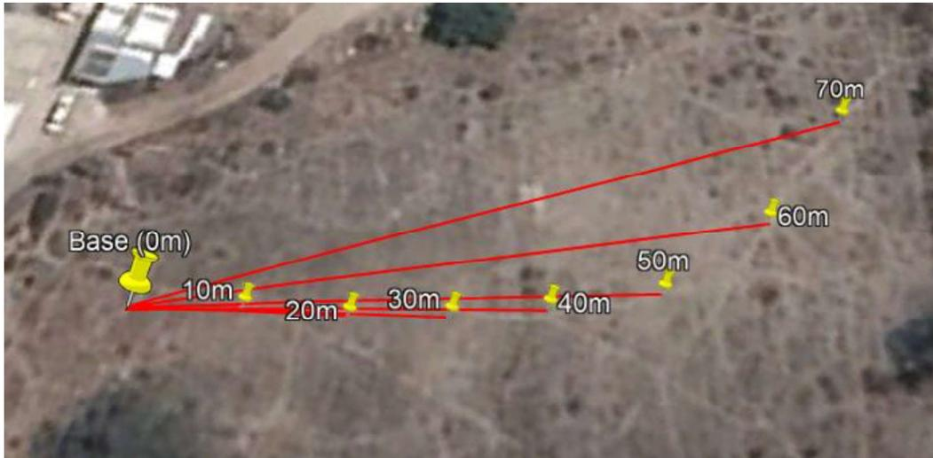
**Figura 81: Puntos de mediciones usadas para Zigbee en RSSI.**
