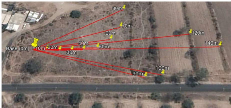
**Figura 89: Puntos de mediciones usadas para Zigbee.**
