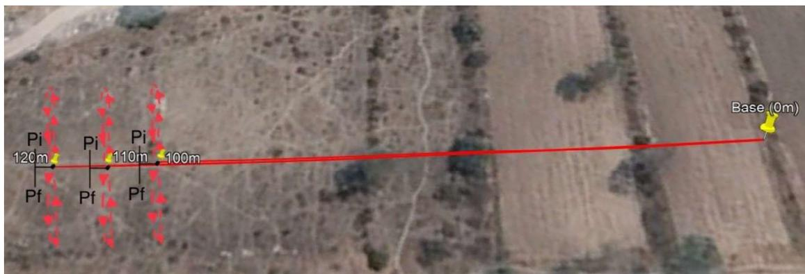
Figura 146: Puntos de mediciones usadas en el escenario NM, elevaciones 1, 2 y 3; bajo el protocolo DigiMesh.
