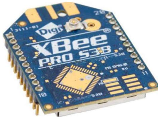
Figura 19: Radio Xbee S3B, obtenido del sitio de compras Mercado Libre[25].
