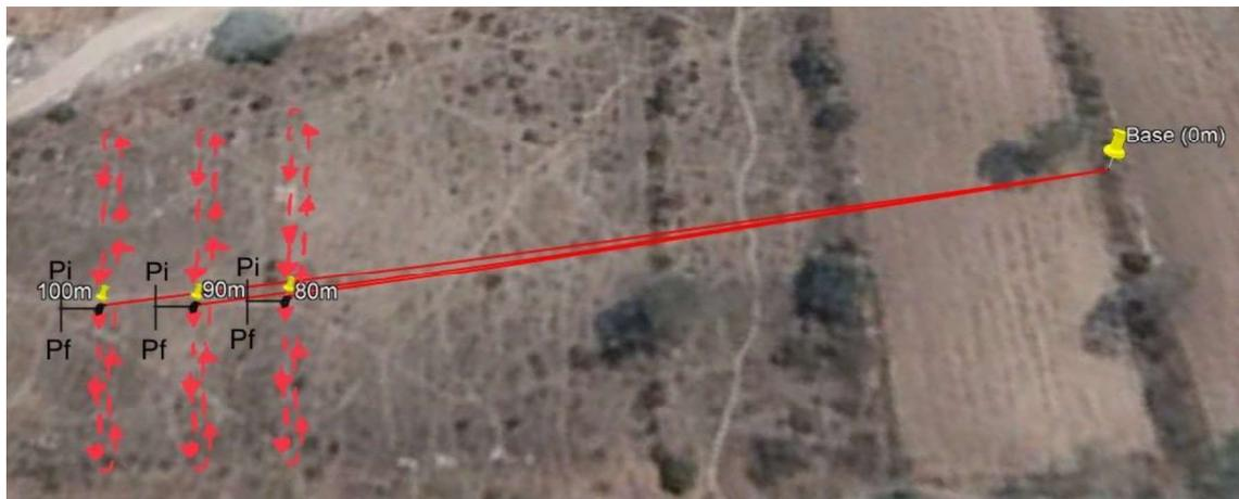
Figura 145: Puntos de mediciones usadas en el escenario NM, elevaciones 1, 2 y 3; bajo el protocolo Zigbee.
