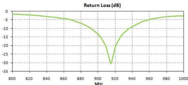
**Figura 39: Gráfica de RL de la antena FXP.290 obtenida de las especificaciones de la antena, página 4[31].**
