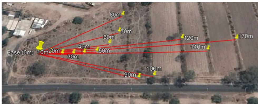
**Figura 90: Puntos de mediciones usadas para DigiMesh.**
