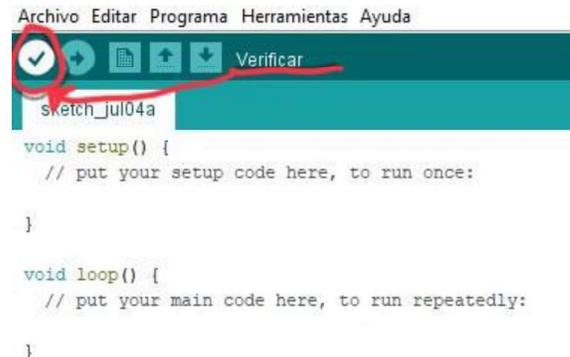
**Figura 58: Paso 2. Verificación de código en el software de Arduino.**
