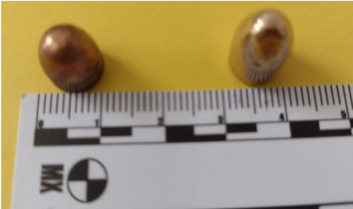
Figura 53. Fotografía de las balas recuperadas de las pruebas con pistola Glock® modelo 17 calibre 9 x 19 mm. Bala del lado izquierdo: utilizada en el primer disparo, permaneciendo en el interior del gel balístico; bala del lado derecho: utilizada en el segundo disparo, abandonó el gel balístico.
