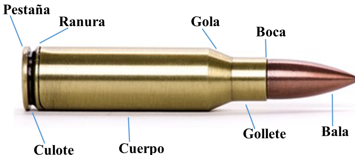
Figura 7. Esquema de las partes que componen el cartucho que puede ser utilizado en armas de ánima rayada [11]
