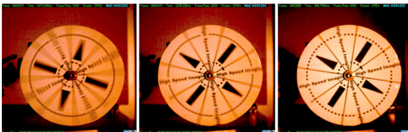
Figura 22. Experimento fotográfico de alta velocidad, usando una cámara moderna de alta velocidad (iluminación continua) con velocidades de cuadros de 1000 fps (izquierda), 2000 fps (centro) y 4000 fps (derecha). [26]
