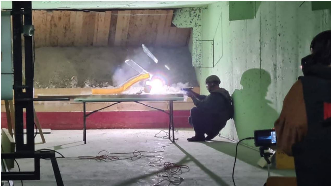
Figura 45. Fotografía de la primera prueba realizada en el stand de tiro de “Rifles Mendoza”. Se observa el momento en el que el proyectil se encuentra en movimiento durante su trayecto a través del gel, causando una liberación de energía que se manifiesta mediante la pérdida de uniformidad de la canaleta. Fotografía por la Dra. Zoraida García Castillo.
