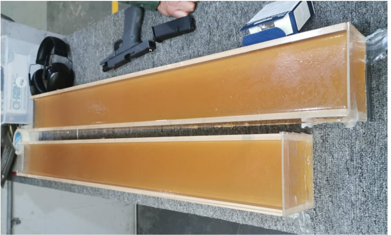
Figura 34. Fotografía de los geles balísticos dentro de la canaleta de acrílico en el stand de tiro. A un costado se observa el arma Glock® modelo 17 calibre 9 x 19 mm empleada.
