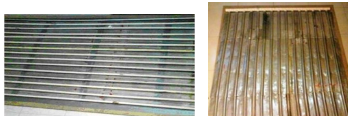
Panel cubierto con lámina de aluminio, por eso no se ve el blanco del CPVC, tomado del Manual de Manual de Ecotecnias Prácticas sustentables.
