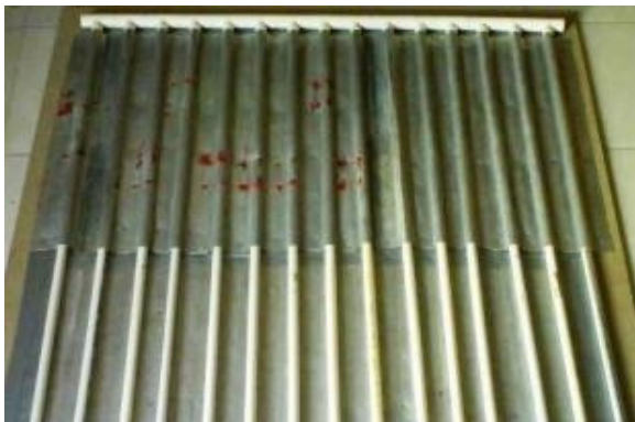
Colocar lámina doblada con los tubos sobre el panel, tomado del Manual de Manual de Ecotecniasy Prácticas sustentables.
