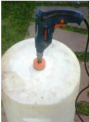
Barrenar para colocar las bridas, tomado del Manual de Manual de Ecotecniasy Prácticas sustentables.
