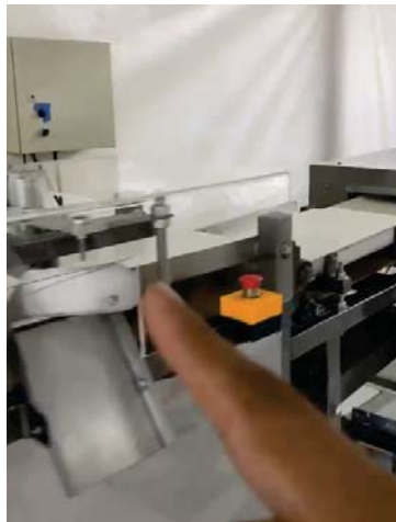
(e) Laminadora entre la extrusora y el túnel
