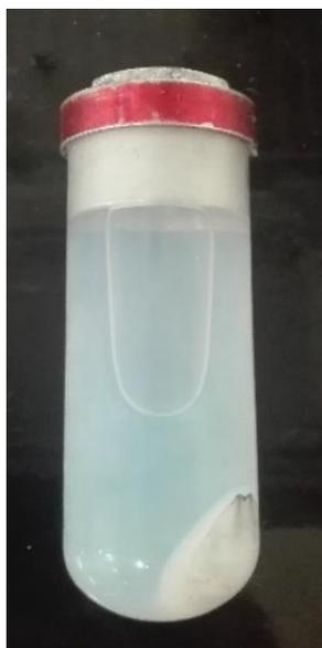
Figura 35. Obtención de sedimento de NP's de EPS.
