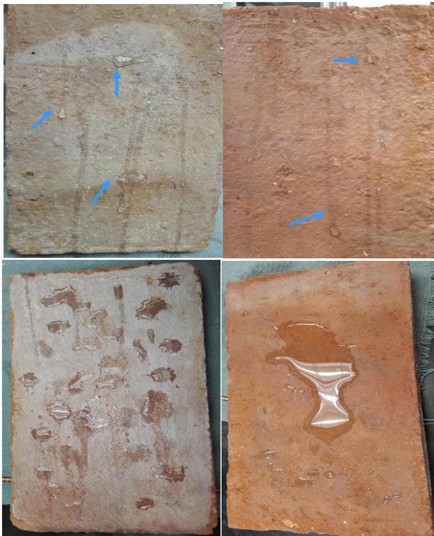
*Figura 44. Repelencia con Película de EPS en Ladrillo*
