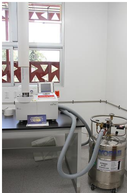
Figura 36. Muestra del instrumental de TGA.
