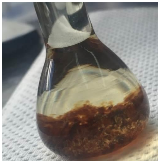
Figura 32. Polibencimidazol obtenido, insoluble en cyrene.
