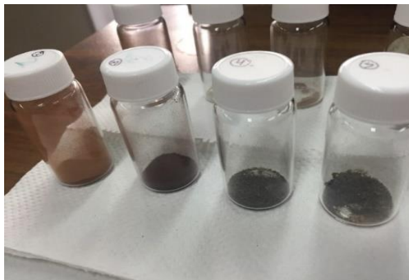
Figura 30. Polímeros obtenidos, el cambio en la coloración aumenta a tonalidades más oscuras en los polímeros de mayor tiempo en la reacción.
