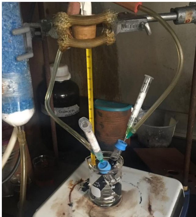
Figura 23. Muestra del equipo montado para la obtención de polibencimidazoles, monitoreando la temperatura, con agitación constante y un flujo suave de Nitrógeno que remueve el aire atrapado en el tubo acarreado a las moléculas de H 2 O generadas en la condensación del polímero.
