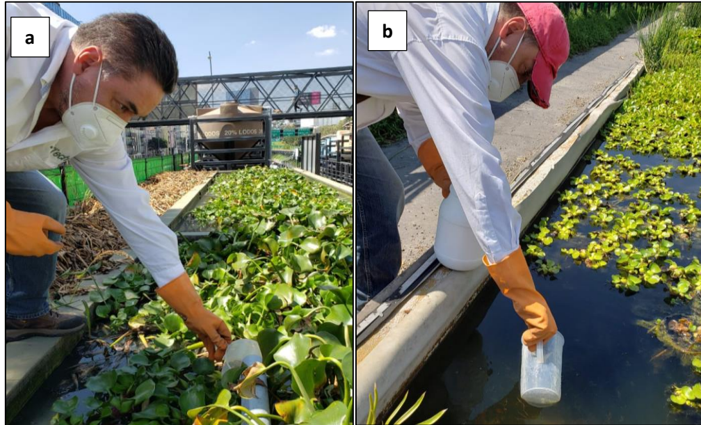
Figura 4.7. Toma de muestra PTAR Ecoducto. a) Agua influente (desarenador). b) Toma de muestra agua efluente PTAR (humedales).
