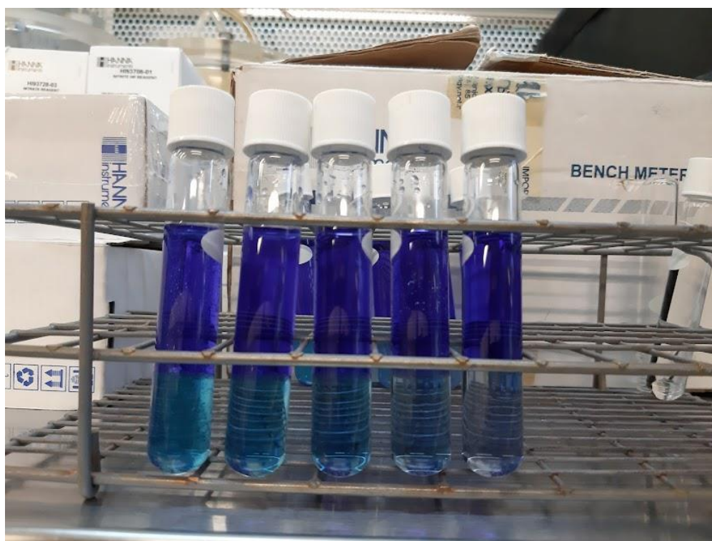
Figura 4.15. Soluciones estándares (2.5– 0 mg/L) para la determinación de la curva de calibración para surfactantes aniónicos.
