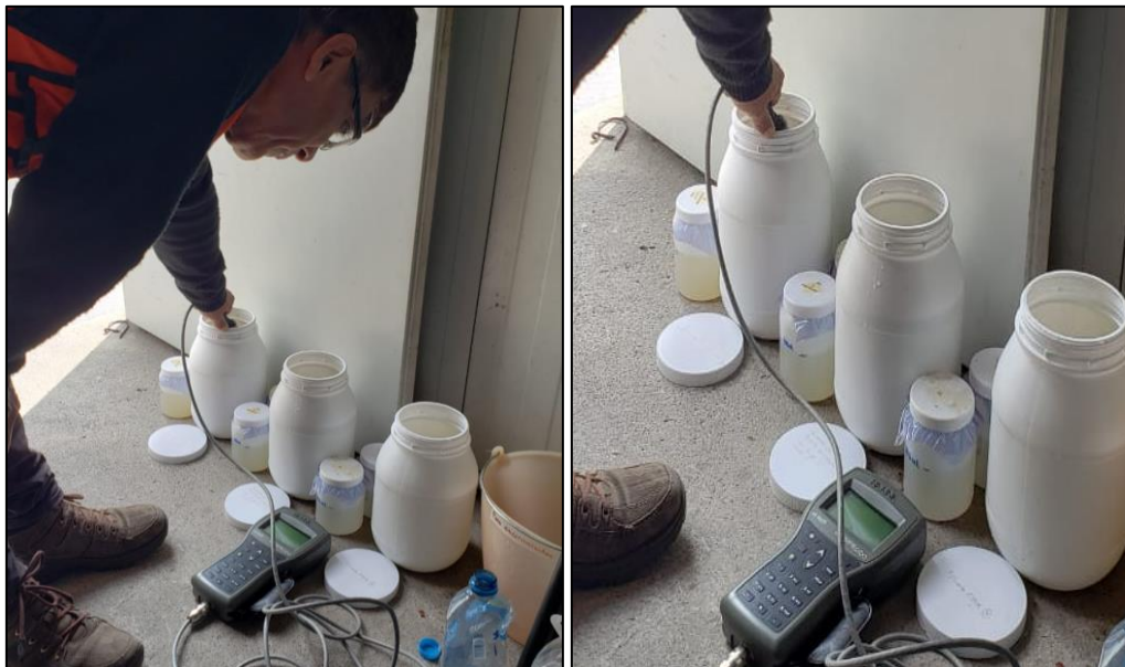
Figura 4.8. Medida de parámetros fisicoquímicos en el sitio, conductividad, temperatura y pH.
