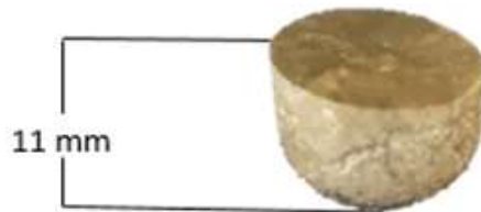
Figura 2. 4. Corte transversal hecho en las muestras de Cu-Al-Ni.
