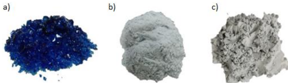
Figura 33. RIV azul: a) sin moler, b) tamizado \leq 75 \mu\text{m} (Malla No. 200) y c) tamizado \leq 38 \mu\text{m} (Malla No. 400).
