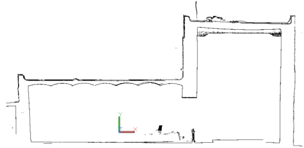
4 Imagen 2D del corte transversal de la sacristía y la nave del Templo de San Jerónimo Lídice obtenida del modelo tridimensional/nube de puntos. K.R.V.
