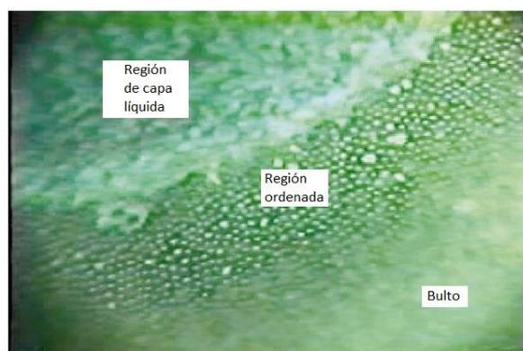
Figura 17.- Ordenamiento de nanopartículas de Látex cargadas en agua desionizada, burbuja (200 de aire  $\mu\text{m}$ ) en cristal, Concentración: 7%vol., Carga superficial:  $0.8 \mu\text{C}/\text{cm}^2$ , tamaño:  $1.01\mu\text{m}$ , Densidad:  $1.05 \text{ g}/\text{cm}^3$  [21].
