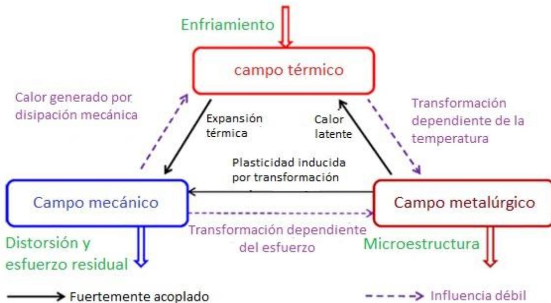
Figura 1.- Acoplamiento entre los campos mecánico, térmico y metalúrgico durante el enfriamiento de una pieza metálica [6].
