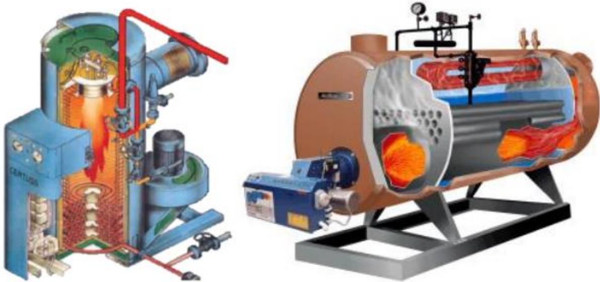
Fig. 2.2 Ejemplo de caldera acuotubular (izquierda) y de caldera pirotubular de dos pasos de humo (derecha) [30].
