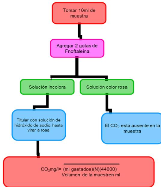
Diagrama de flujo 3 Método de determinación de Bióxido de Carbono Microescala
