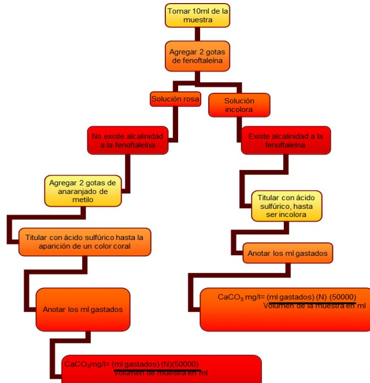
Diagrama de flujo 3 Método de determinación de Alcalinidad Microescala
