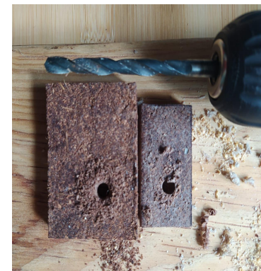
Imagen 86. Barrenado en muestra de coco de 9 mm y 6 mm.
