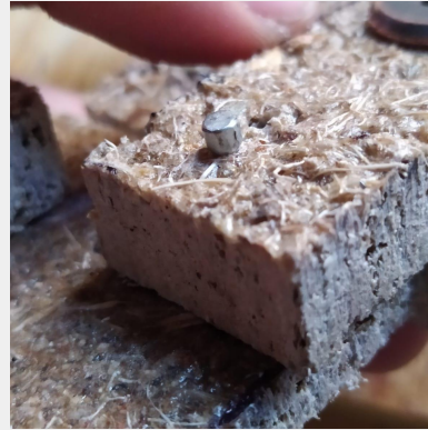
Imagen 90. Muestra de agave de 9 mm con clavo de 1"
