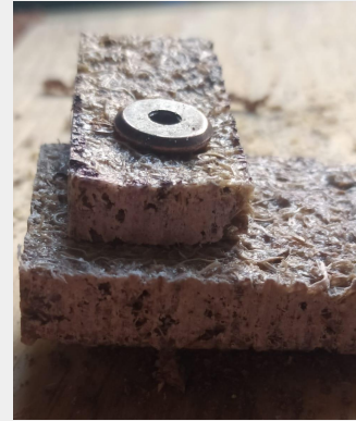
Imagen 91. Muestra de agave de 6 mm con tuerca inserto M5 y tornillo milimétrico con cabeza hexagonal plana.
