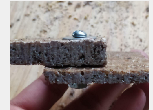
Imagen 96. Muestra de agave de 6 mm y 9 mm con tornillo de 1/8" x 2" estándar con rondana y tuerca hexagonal.
