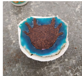
Imagen 115. Prueba en molde comercial de caucho de silicón. Derechos de autor del molde a: Sergio Alejandro Viaña Fragoso.
