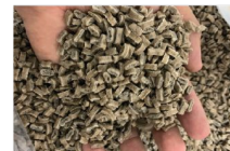
Prototipos de concentrados y piezas fabricadas con poliolefinas y fibra de agave fabricados. Recuperado de CIQA (s.f).
