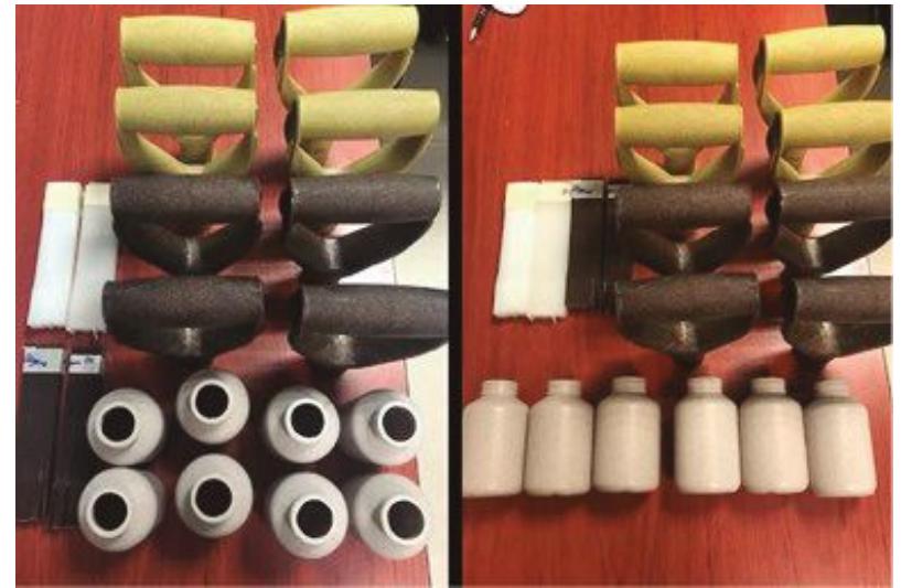
Imagen 16. Productos derivados del agave y polímeros, proceso de extrusión realizado por CIQA
