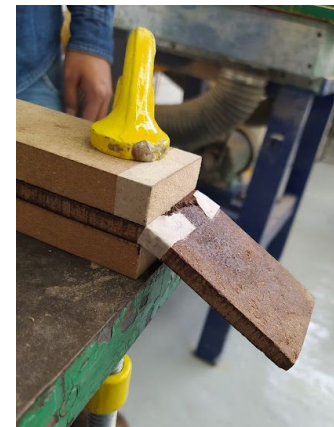
Imagen 63. Rotura en muestra de coco de 6 mm a los 5.5 kg.
