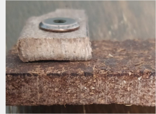
Imagen 92. Muestra de coco de 6 mm y 9 mm con tuerca inserto M5 y tornillo milimétrico con cabeza hexagonal plana.
