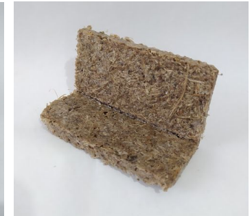
Imagen 100. Muestra de agave de 6 mm con pegamento acetato de polivinilo.
