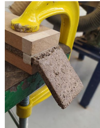
Imagen 62. Rotura en muestra de agave de 6 mm a los 5 kg.
