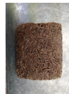
Imagen 112. Moldeado de sobrantes de agave después de ser sumergidos en acetona.
