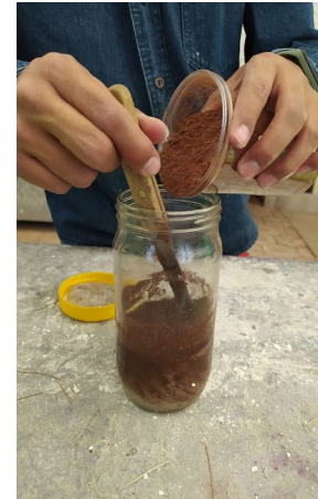
Imagen 38. Mezcla de fibra de coco con EPS y Acetona.
