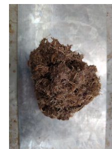
Imagen 110. Sobrantes de muestras de agave sumergidas en acetona después de 30 hrs.
