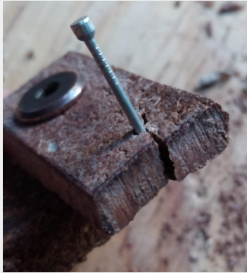
Imagen 89. Fractura en muestra de coco de 6 mm con clavo de 1"
