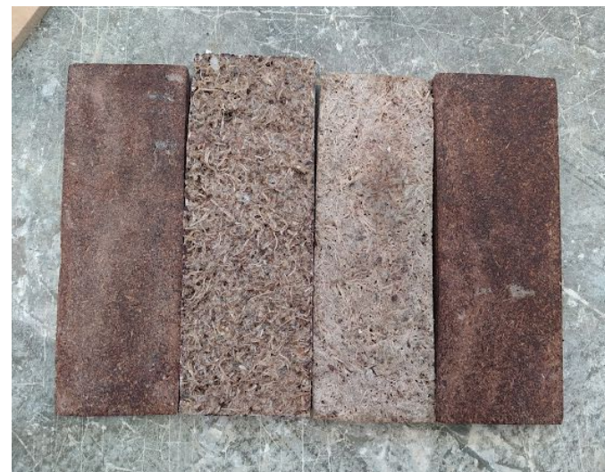
Imagen 44. Muestras de 150x50 mm de fibra de coco y agave con EPS.
