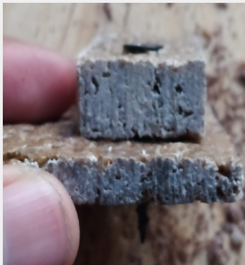
Imagen 93. Muestra de agave de 6 mm y 9 mm con pija para madera de 14x3mm 1/2"
