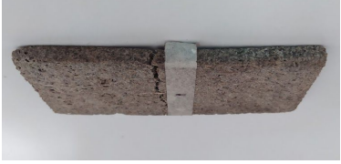
Imagen 53. Muestra de fibra de agave con EPS (150x50x6 mm) después de ser sometida a prueba de flexión.
