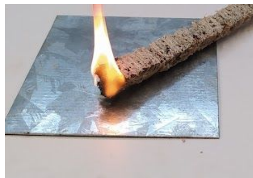
Imagen 80. Muestra de agave expuesta a flama directa.
