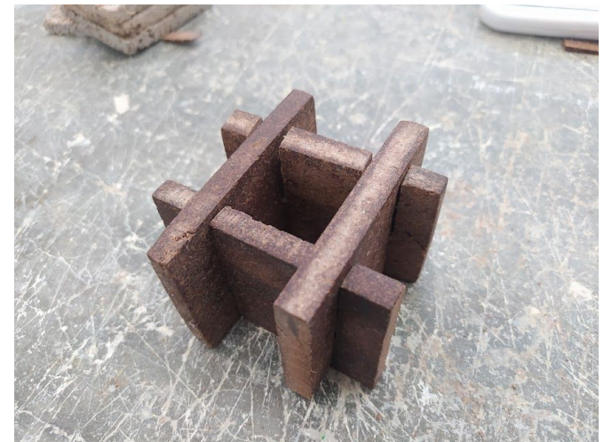
Imagen 98. Prueba de ensamble de ranura en muestra de coco de 9 mm.
