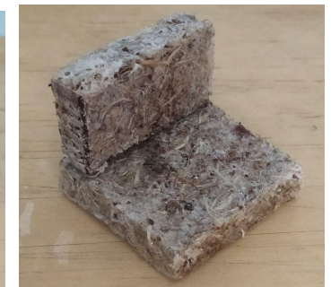
Imagen 102. Muestra de agave de 9 mm con pegamento epóxico.
