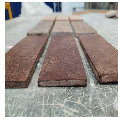
Imagen 48. Textura en muestras de fibra de coco con EPS.
