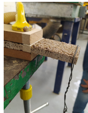
Imagen 65. Flexión en muestra de agave de 9 mm a los 10 kg.
