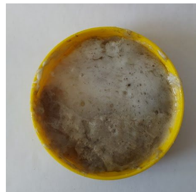
Imagen 37. Dilución de EPS en Acetona, escala 1:1.
