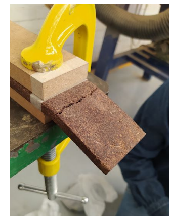
Imagen 64. Rotura en muestra de coco de 9 mm a los 6 kg.
