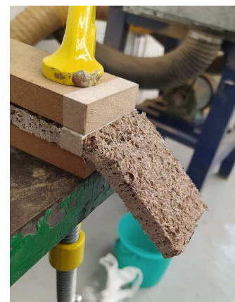
Imagen 66. Rotura en muestra de agave de 9 mm a los 10.5 kg.
