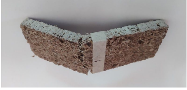
Imagen 54. Muestra de fibra de agave con EPS (150x50x9 mm) después de ser sometida a prueba de flexión.
