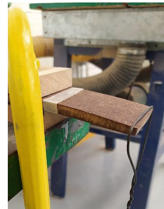
Imagen 60. Flexión en muestra de coco de 6 mm a los 5 kg.
