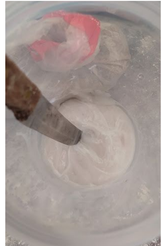
Imagen 34. Dilución de EPS en acetona.
