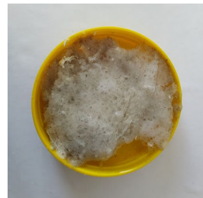
Imagen 36. Dilución de EPS en Acetona, escala 1:2.
