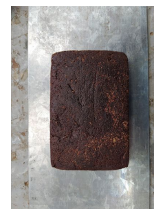
Imagen 111. Moldeado de sobrantes de coco después de ser sumergidos en acetona.
