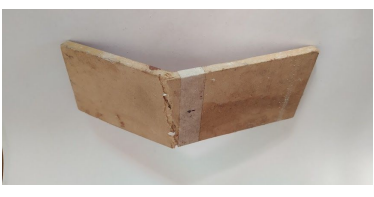
Imagen 58. Muestra de MDF (150x50x9 mm) después de ser sometida a prueba de flexión.
