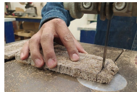
Imagen 82. Muestra de agave de 9 mm sometida a corte en sierra cinta.
