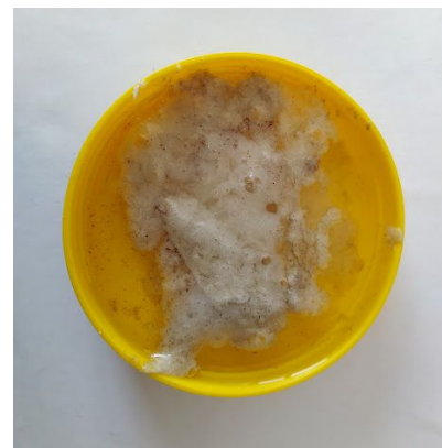
Imagen 35. Dilución de EPS en Acetona, escala 1:3.
