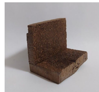
Imagen 105. Muestra de coco de 9 mm con pegamento cianoacrilato.
