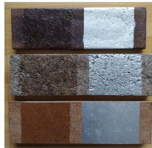
Imagen 68. Muestras con nitrocelulosa y esmalte acrílico.
