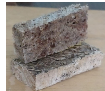
Imagen 104. Muestra de agave de 9 mm con pegamento de contacto.
