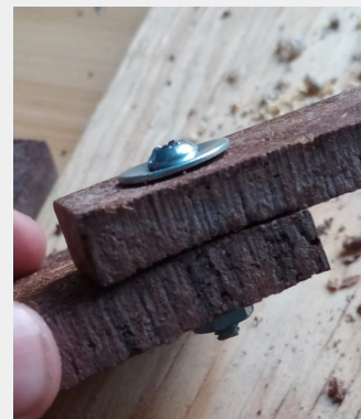
Imagen 95. Muestra de coco de 6 mm con tornillo de 1/8" x 2" estándar con rondana y tuerca hexagonal.
