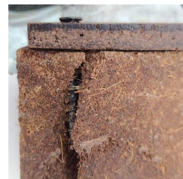
Imagen 88. Unión con pija en muestra de coco de 6 mm.
