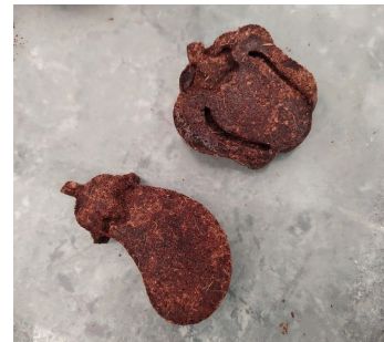
Imagen 114. Muestras resultantes de moldes de PP.
