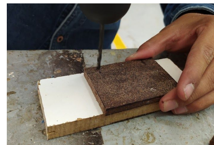
Imagen 84. Muestra de coco de 6 mm sometida a barrenado con taladro.
