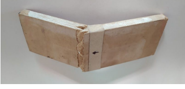
Imagen 57. Muestra de MDF (150x50x6 mm) después de ser sometida a prueba de flexión.
