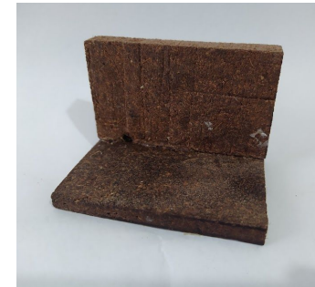
Imagen 99. Muestra de coco de 6 mm con pegamento acetato de polivinilo.
