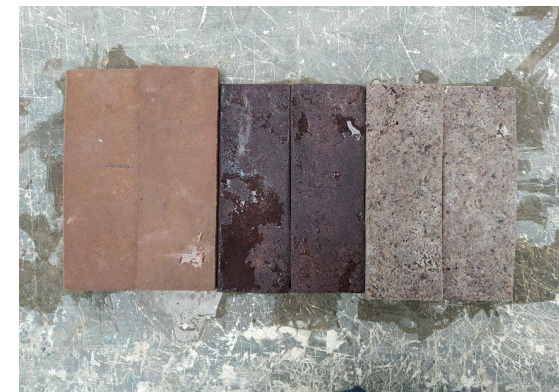
Imagen 52. Muestras húmedas de MDF, fibra de coco y agave con EPS.
