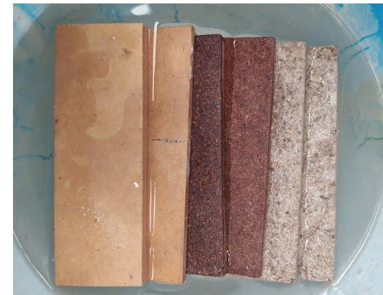
Imagen 51. Muestras en agua de MDF, fibra de coco y agave con EPS.
