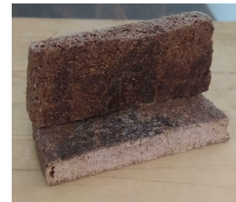
Imagen 103. Muestra de coco de 9 mm con pegamento de contacto.
