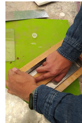
Imagen 40. Compresión manual de la muestra en molde.
