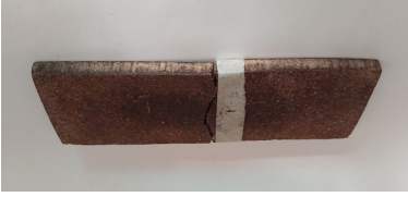
Imagen 55. Muestra de fibra de coco con EPS (150x50x6 mm) después de ser sometida a prueba de flexión.
