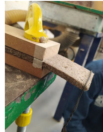
Imagen 59. Flexión en muestra de agave de 6 mm a los 4.5 kg.
