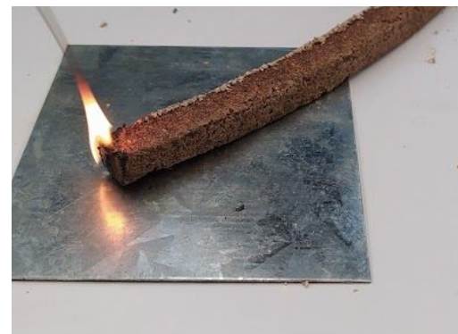
Imagen 81. Muestra de coco expuesta a flama directa.
