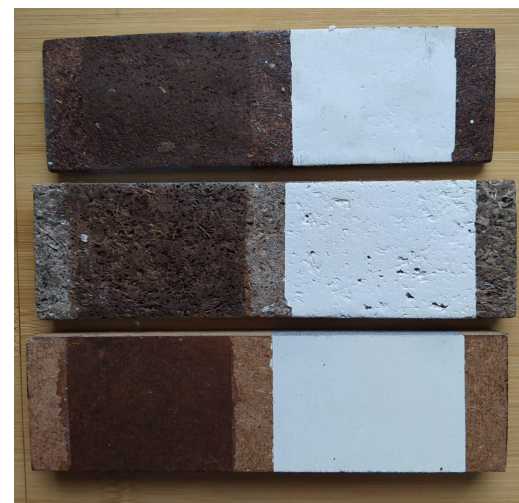
Imagen 69. Muestras con tinta al alcohol y vinilica.
