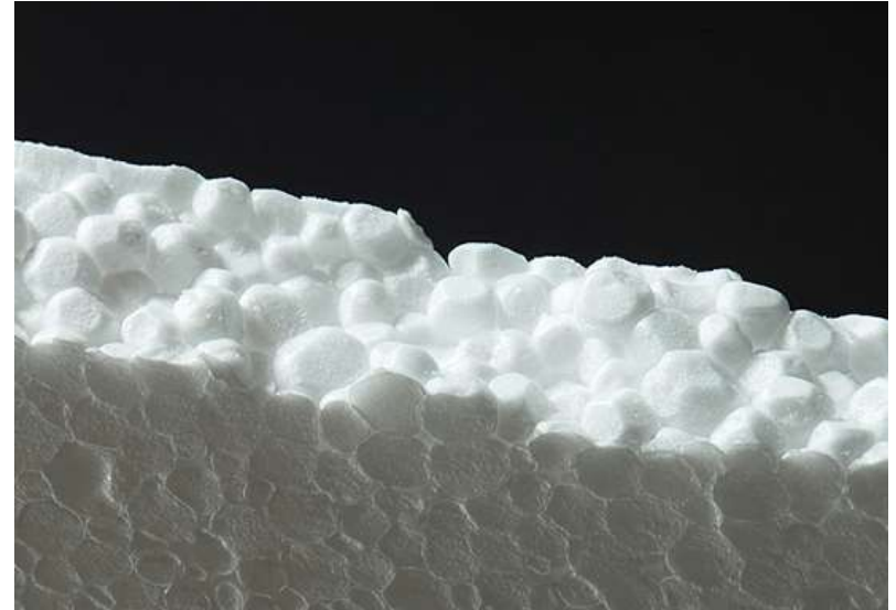
Imagen 19. Textura EPS. Recuperado de Plastics Technology México (2017)
