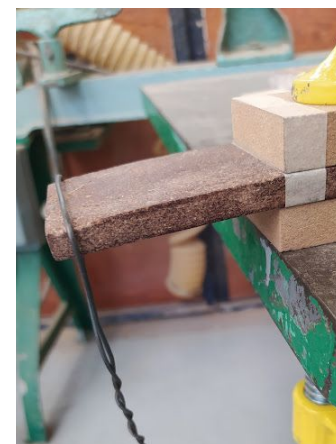
Imagen 61. Flexión en muestra de coco de 9 mm a los 5.5 kg.
