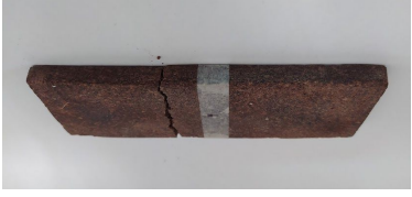
Imagen 56. Muestra de fibra de coco con EPS (150x50x9 mm) después de ser sometida a prueba de flexión.
