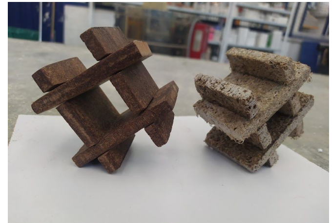
Imagen 97. Prueba de ensamble de ranura en muestras de coco y agave de 9 mm.
