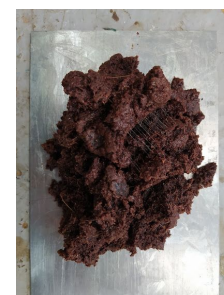
Imagen 109. Sobrantes de muestras de coco sumergidas en acetona después de 30 hrs.
