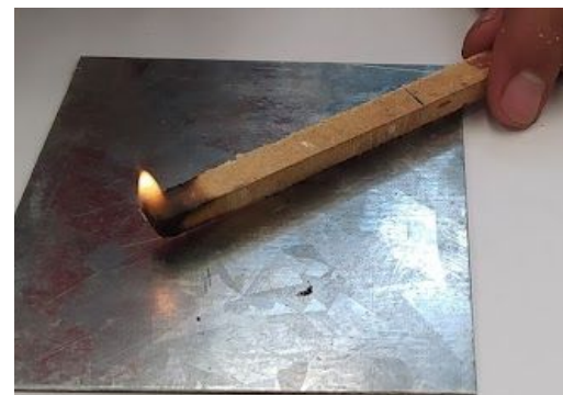
Imagen 79. Muestra de MDF expuesto a flama directa.
