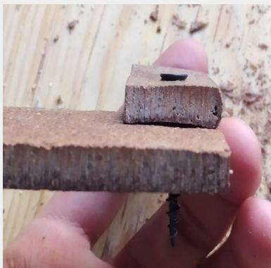
Imagen 94. Muestra de coco de 6 mm con pija para madera de 14x3mm 1/2"
