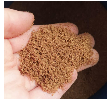
Imagen 32. Fibra de coco molida y tamizada.
