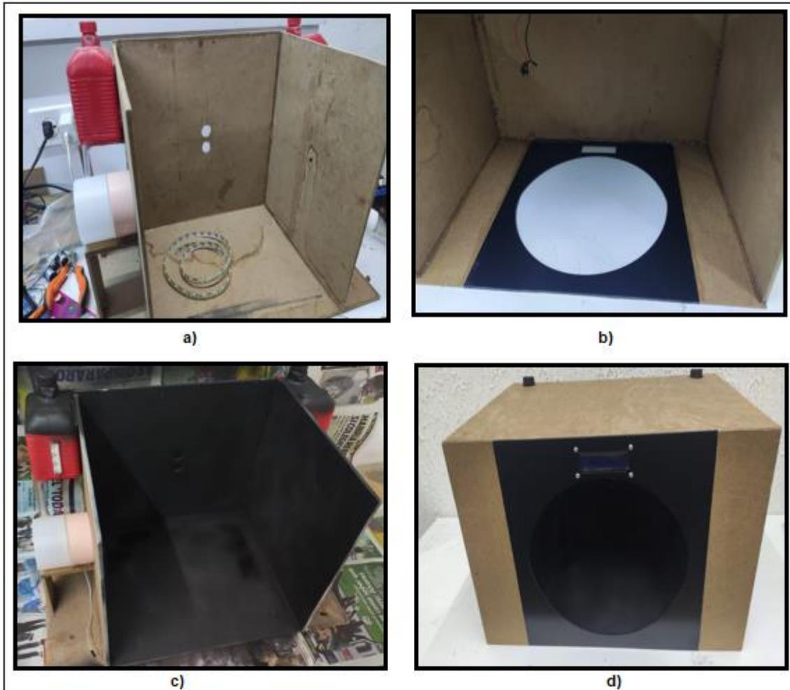
Figura 4.7. Ilustración del diseño de la caja sanitizadora
