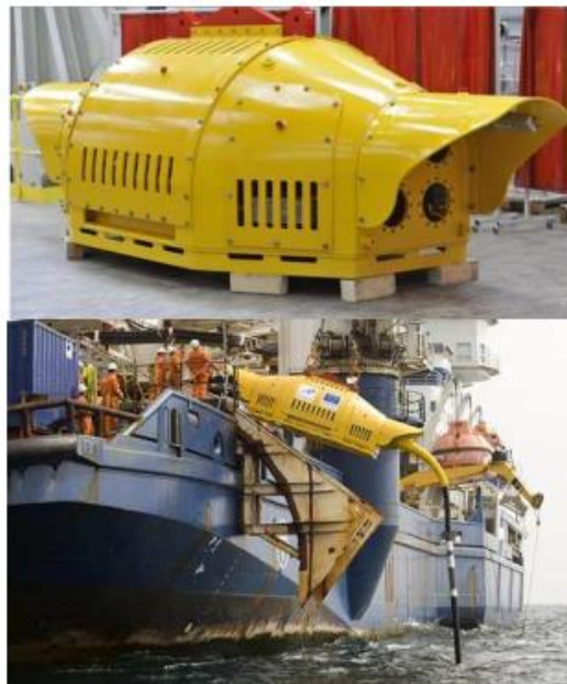
Fig. 46 Estación de interconexión de Wavehub
