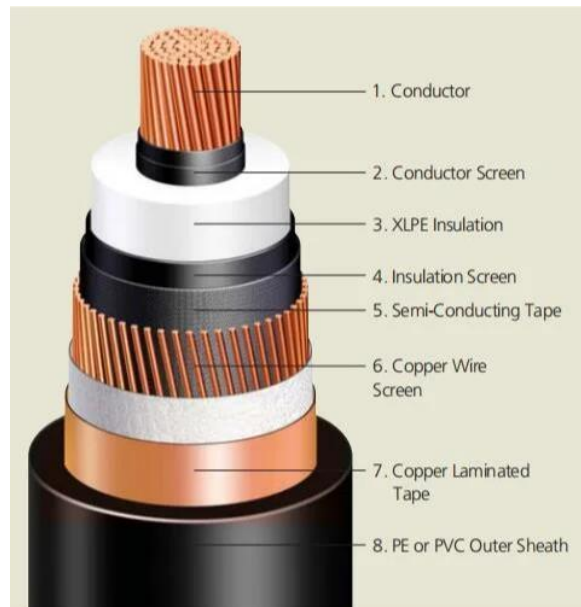
Fig. 19 Cable de polietileno reticulado (XLPE) 1.-conductor. 2.-Pantalla del conductor. 3.-Aislamiento XLPE. 4.-Pantalla de aislamiento. 5.-Cinta semiconductora. 6.- Pantalla de alambre de cobre. 7.- Cinta laminada de cobre. 8.- Revestimiento exterior de PE o PVC.
