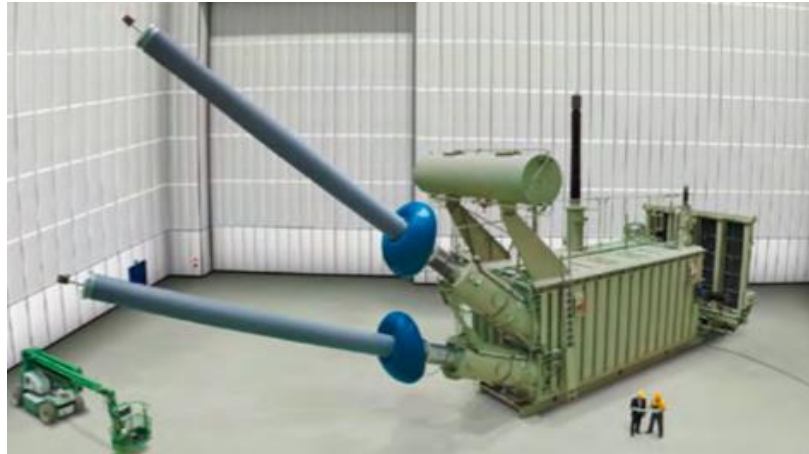
Fig. 7 Transformador convertidor para UHVDC de un sistema de transmisión bipolar de 800 KVDC, 6400MW; 2,071Km, una sola fase; 550 KVAC, 816kVdc; 321MVA; alimentación en estrella de alto pulso.
