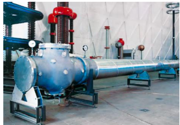
Fig. 55 Muestra de laboratorio de Siemens para pruebas dieléctricas
