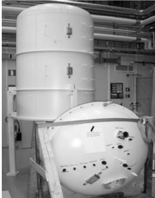
Fig. 41 Subestación submarina diseñada por la universidad de Uppsala.
