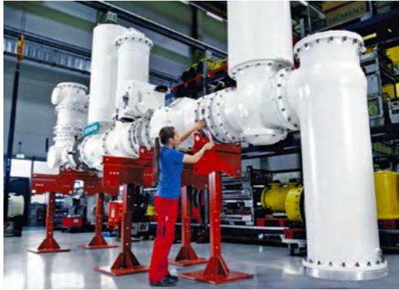
Fig. 37 Subestación de control compacta de 320 kV DC en la fábrica de Siemens
