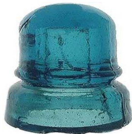
Fig. 31 Aislador de vidrio fracturado
