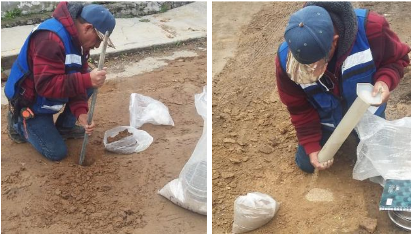
22.-IMAGEN PERSONAL MUESTREO DE PRUEBAS DE COMPACTACIÓN (PROCTOR).
