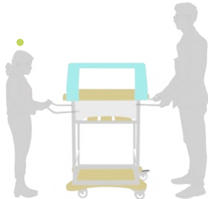
Fig. 51 Posición de empuje de sujetos de prueba del 5 y 95 percentil con agarradera tipo A y B
