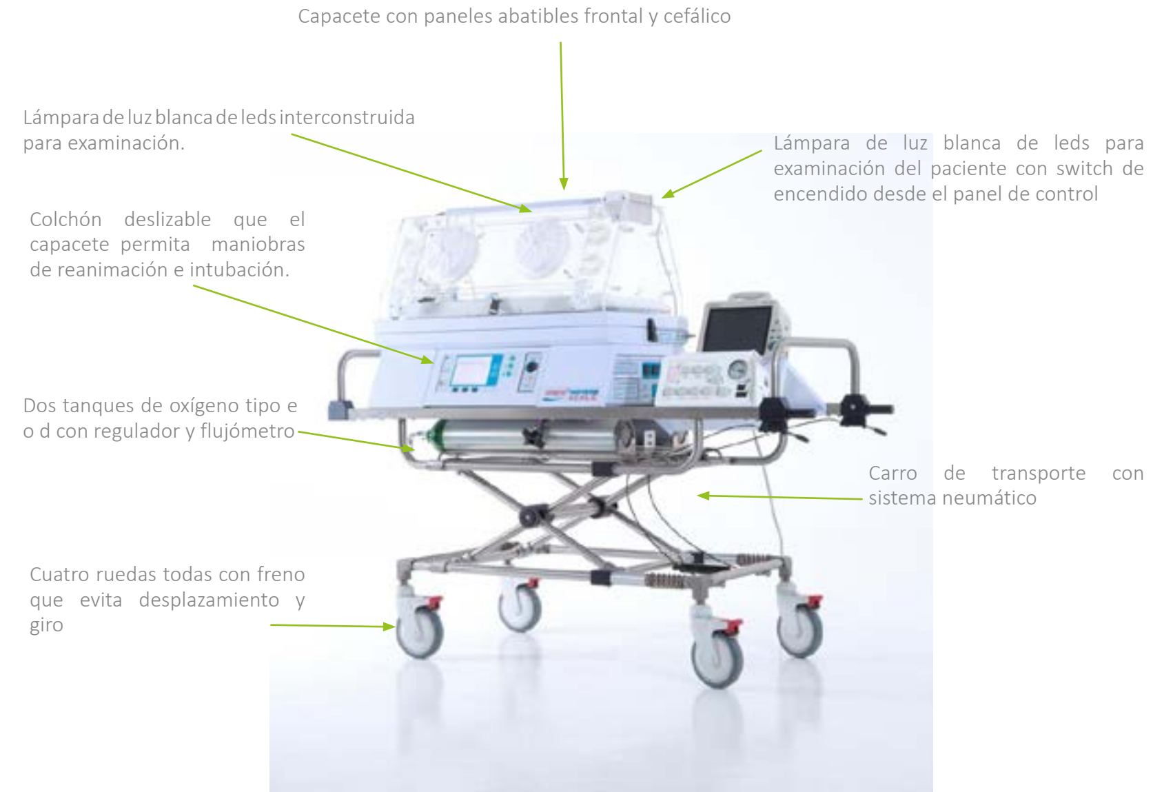
Fig. 19 Características de la incubadora de traslado SAPS Isotherm Scale Arroba Ingeniería. (2020).
