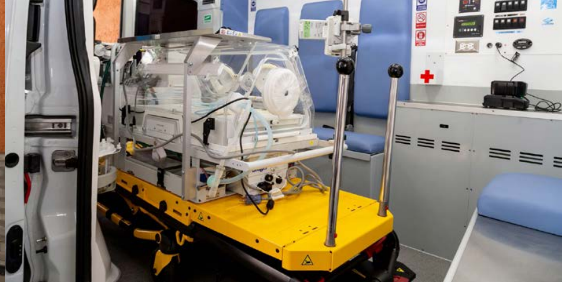
Fig. 22 Interior de la ambulancia, equipado con una incubadora marca Dräger y carro camilla eléctrica Secretaría de Salud. (2018).
