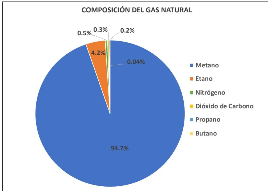
Componentes del gas natural expresados en porcentaje (aproximado). Adaptado de Metrogas. (2021). *Folleto Técnico Gas Natural* [Gráfico]. [http://www.metrogas.cl/userfiles/file/folleto\\_metrogas\\_gas\\_natural.pdf](http://www.metrogas.cl/userfiles/file/folleto_metrogas_gas_natural.pdf).
