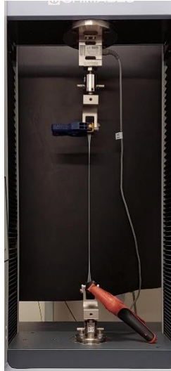
Figura 4.9 Especímen tipo D, ensayado hasta ruptura a una velocidad de 500 mm/min.
