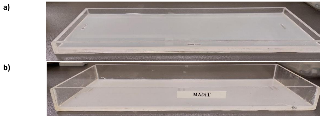
Figura 4.4 a) Contenedor 1 con 190 [g] para la obtención de la primer placa de Ecoflex 00-30, b) Contenedor 2 con 210 [g] para la obtención de la segunda placa de Ecoflex 00-30.
