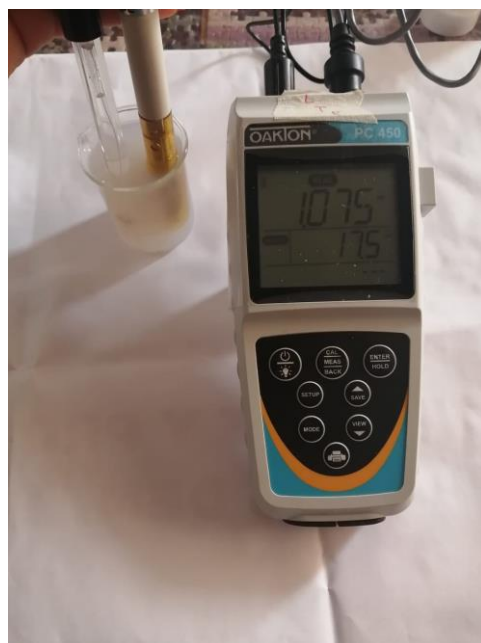
Figura 18. Montaje del equipo, para la medición de conductividad y pH en la muestra de agua residual de lavadora doméstica.
