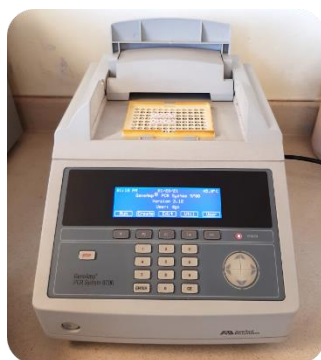
Figura 18. Termociclador GeneAmp™ PCR System 9700
