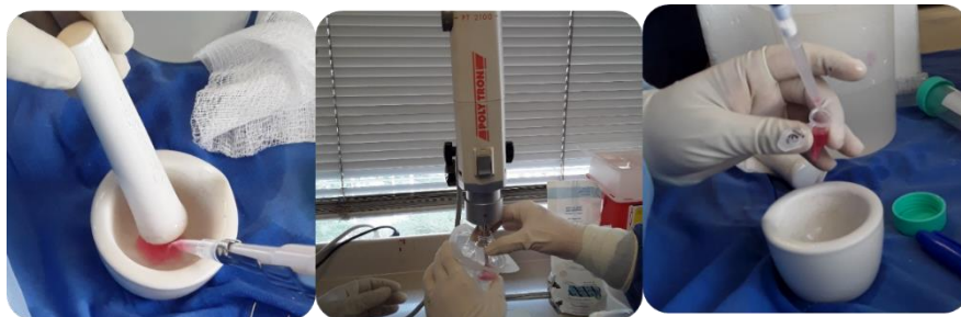
Figura 15. Homogenización de la muestra e inactivación de RNAsas con TRIzol™
