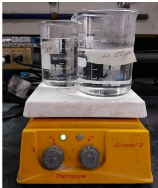
Figura 2.2. Sellado de las placas con solución de LaCl<sub>3</sub>
