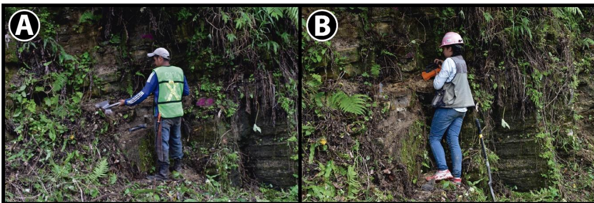
Figura 4.3 Metodología empleada para la medición de rayos gamma: A) limpieza en la superficie exterior de la roca antes de la medición de rayos gamma; B) medición sistemática de radiación de rayos gamma con el equipo portátil RS-125 Super Gamma.
