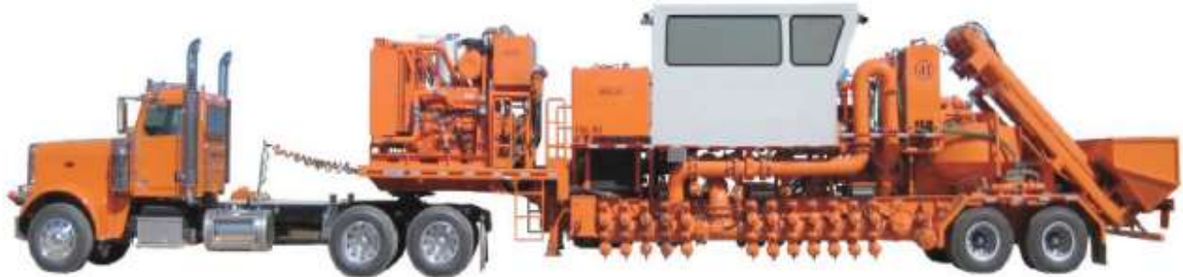
Ilustración 1-3 Mezclador de productos químicos y apuntalante (Blender) [5].
