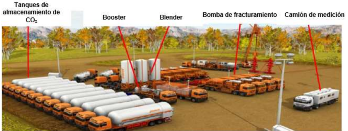
Ilustración 3-7 Equipos de trabajo del proceso de fracturamiento con CO 2 líquido. [43]
