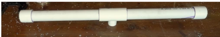
Figura 15. Fuente de elaboración propia. Se unieron las tapas de \frac{3}{4} de pulgada en los extremos de la tubería
