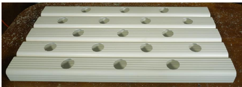
Figura 11. Fuente de elaboración propia. Agujeros de 4.5 cm de diámetro alternados en forma de tablero de ajedrez
