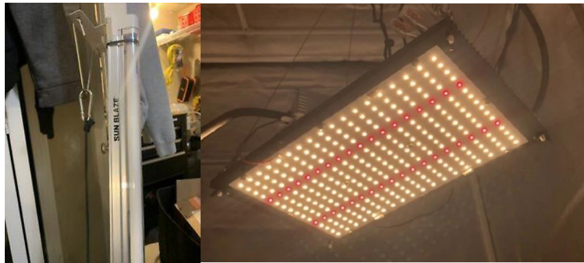
Figura 21. Fuente de elaboración propia, lámpara Sun Blaze Figura 22. Fuente de elaboración propia, lámpara led Samsung LM301H
