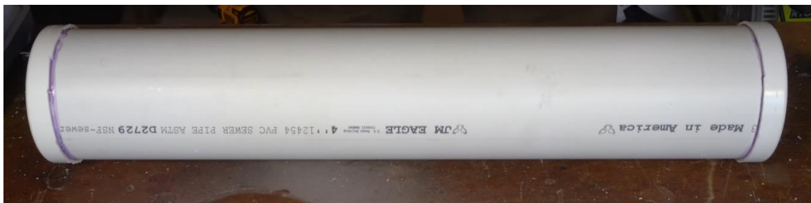
Figura 12. Fuente de elaboración propia. Se unieron las tapas de \frac{3}{4} de pulgada en los extremos de la tubería
