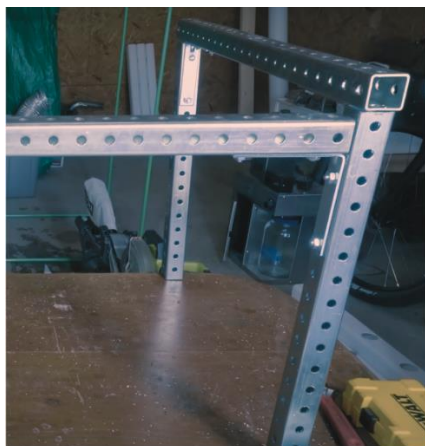
Figura 9. Fuente de elaboración propia. se atornillo cada extremo a todos los conjuntos de patas traseras
