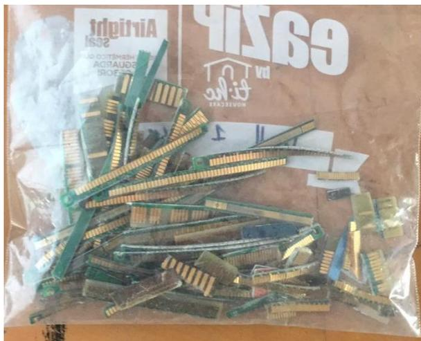
Figura 4.20. Material de pines de tarjetas, (Elaboración propia, 2021)
