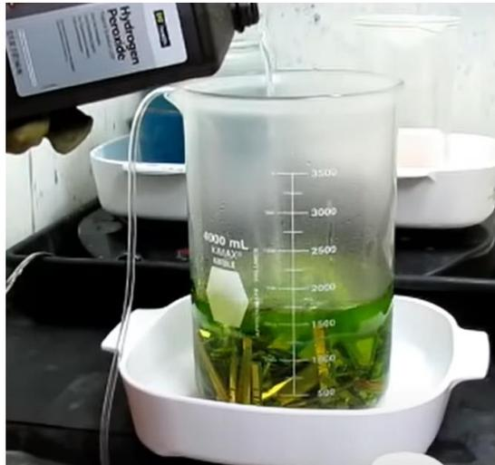
Figura 4.21. Tarjetas en mezcla ácida. (sreetips, 2015)
