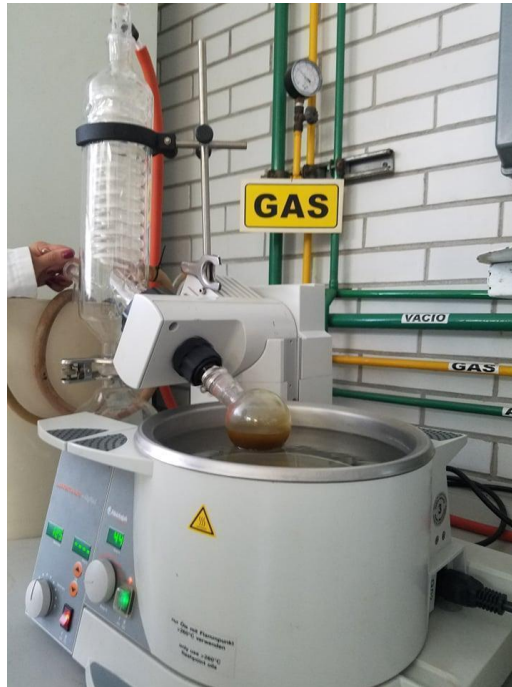
Figura 4. Extracción de extractos en rotaevaporador
