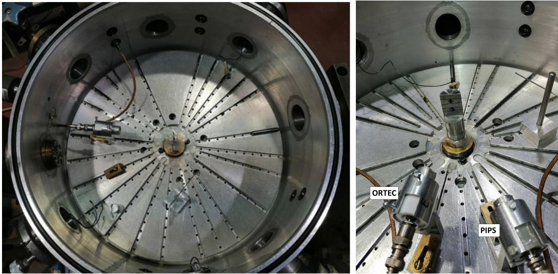
Figura 3.2: Cámara de reacción, se muestra el arreglo del blanco con los detectores, desde dos puntos de vista.
