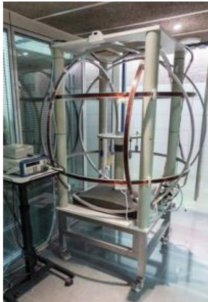
Figura. 3. Simulador de campo magnético del NanoSat Lab.
