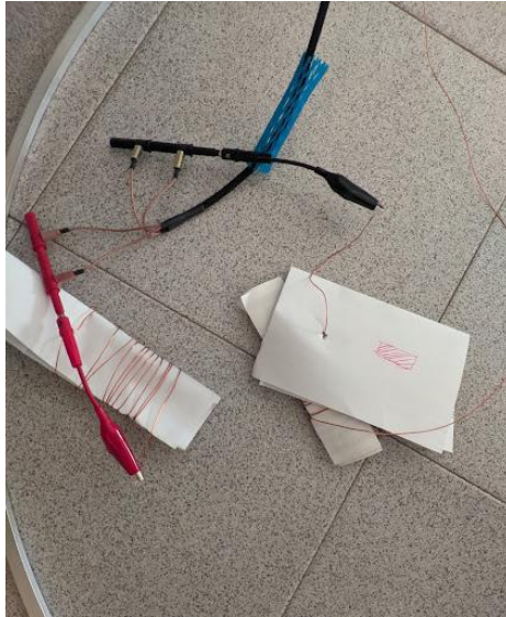
Figura. 19. Conexión de la bobina al instrumento de medición.
