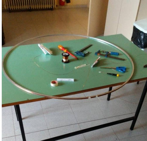
Figura. 16. Bobina con los materiales para su construcción.
