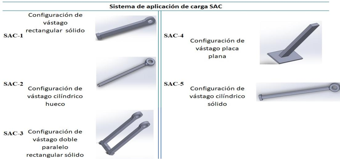
**Figura 4.12:** Alternativa de solución para el Sistema de Carga
