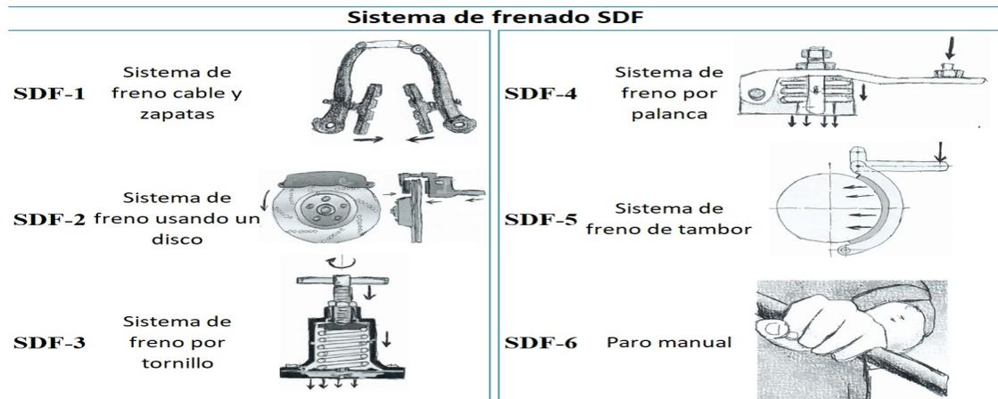
**Figura 4.18:** Alternativa de solución para el Sistema de Frenado
