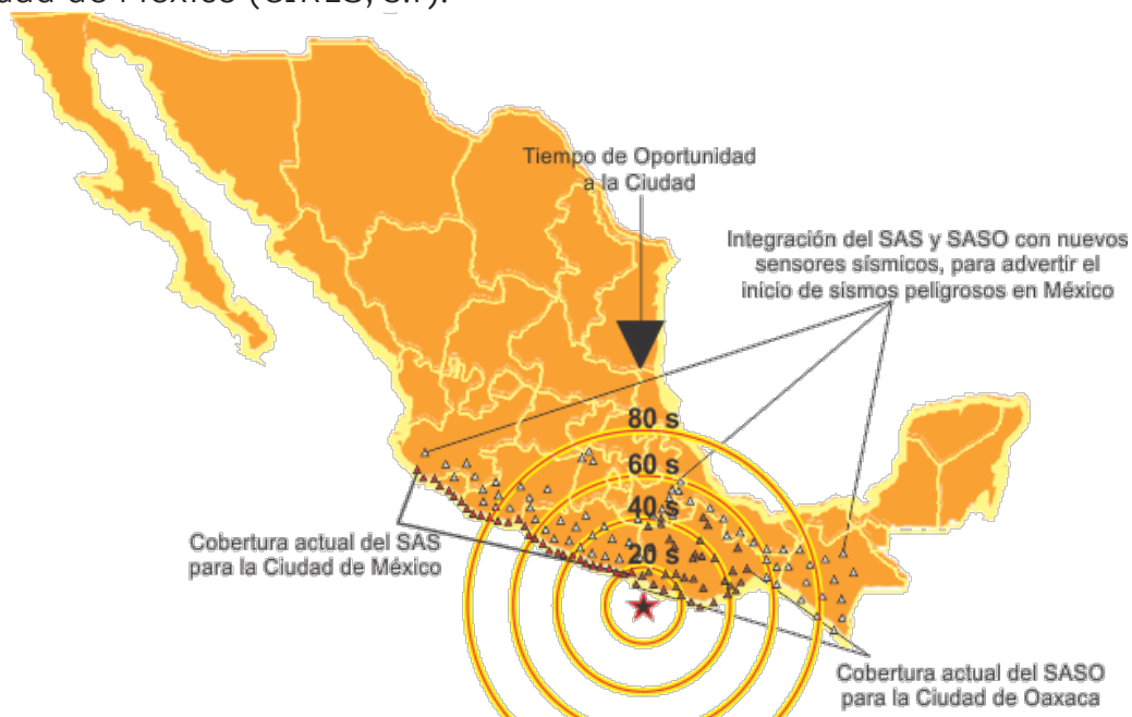
Mapa 1.4 Tiempo de transmisión del SASMEX desde el hipocentro hacia los lugares aledaños. Recuperado 2019 de CIRES, s.f.
