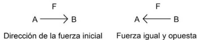
Figura 2.2 Esquema que representa la manera en la que se ejercen las fuerzas de acción y reacción en los cuerpos A y B. Creación de la autora con información de Pérez, 2002, p.145.
