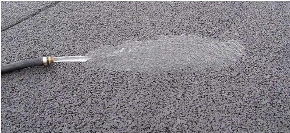
Figura 28. Concreto permeable. Arquigrafico ,( 2016)
