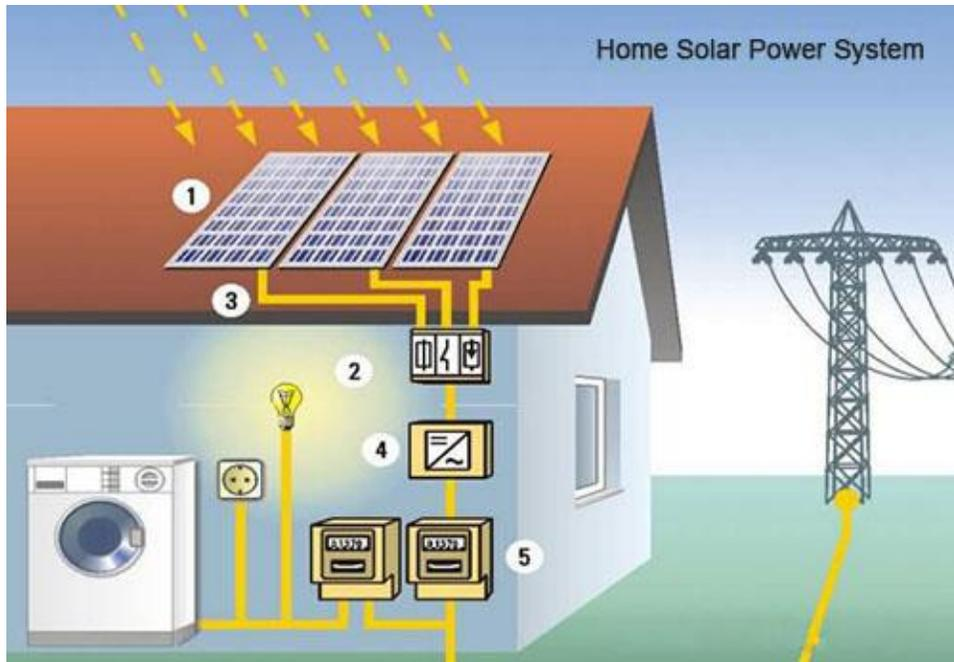
Figura 8. Sistema de paneles solares. (Big solar , 2017)
