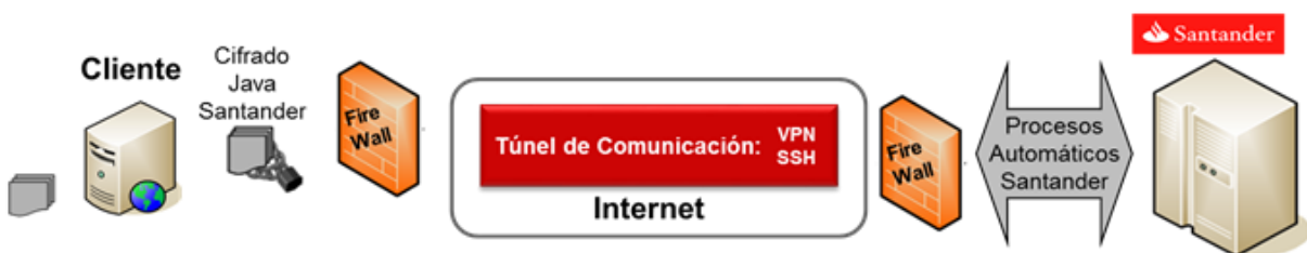
Ilustración 22 Detalle Técnico para la construcción de VPN Site to Site y el Flujo
