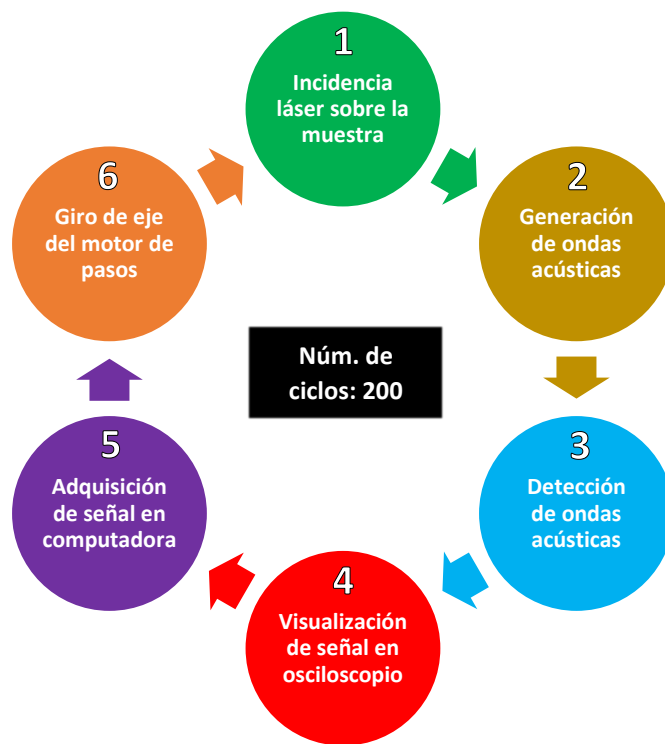
Figura 19. Esquema que representa el ciclo básico para la adquisición de las 200 señales fotoacústicas.
