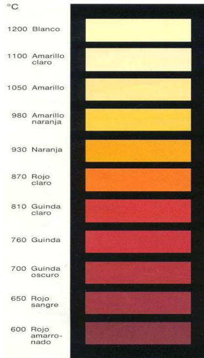
Figura 3.4 Relación entre la temperatura y el color en la zona de forja para Aceros 27 .
