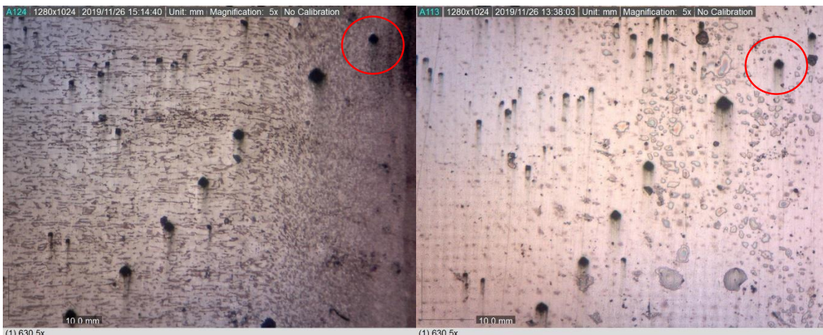
Figura 4.1.4 Perfil de microdureza partiendo de la interfase (derecha a izquierda), en la Probeta 1. Con ataque (izquierda), sin ataque (derecha) a 5x.
