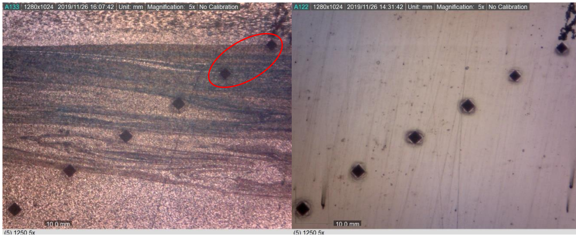
Figura 4.1.18. Perfil de microdureza partiendo de la interfase (arriba a abajo), en la Probeta 5. Con ataque (izquierda), sin ataque (derecha) a 5x.
