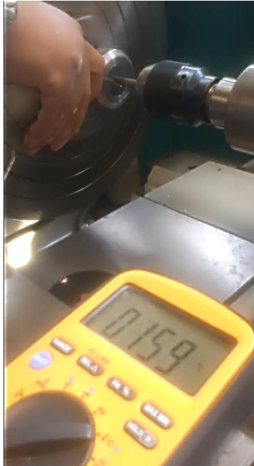
Figura 3.3 Imagen sustraída de una de las grabaciones donde se muestra la colocación del termopar para la determinación de las curvas de calentamiento.
