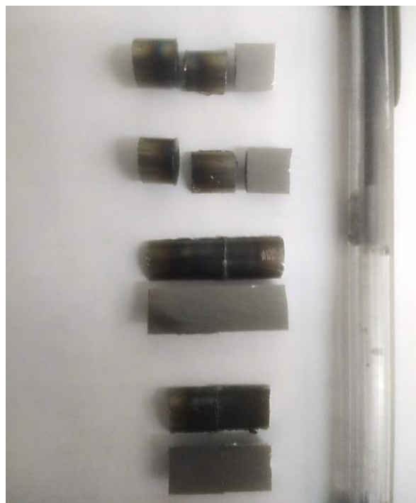
Figura 3.5 Probetas destinadas al análisis de temperatura en interfase: A, B, C y D (orden de arriba hacia abajo, respectivamente) después del corte transversal.
