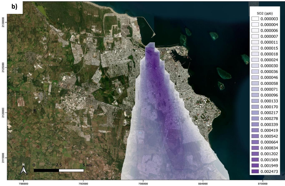
Figura 64. Dispersión promedio diario de \text{PM}_{10} (a) y \text{SO}_2 (b) caso de estudio de 13-11-2017
