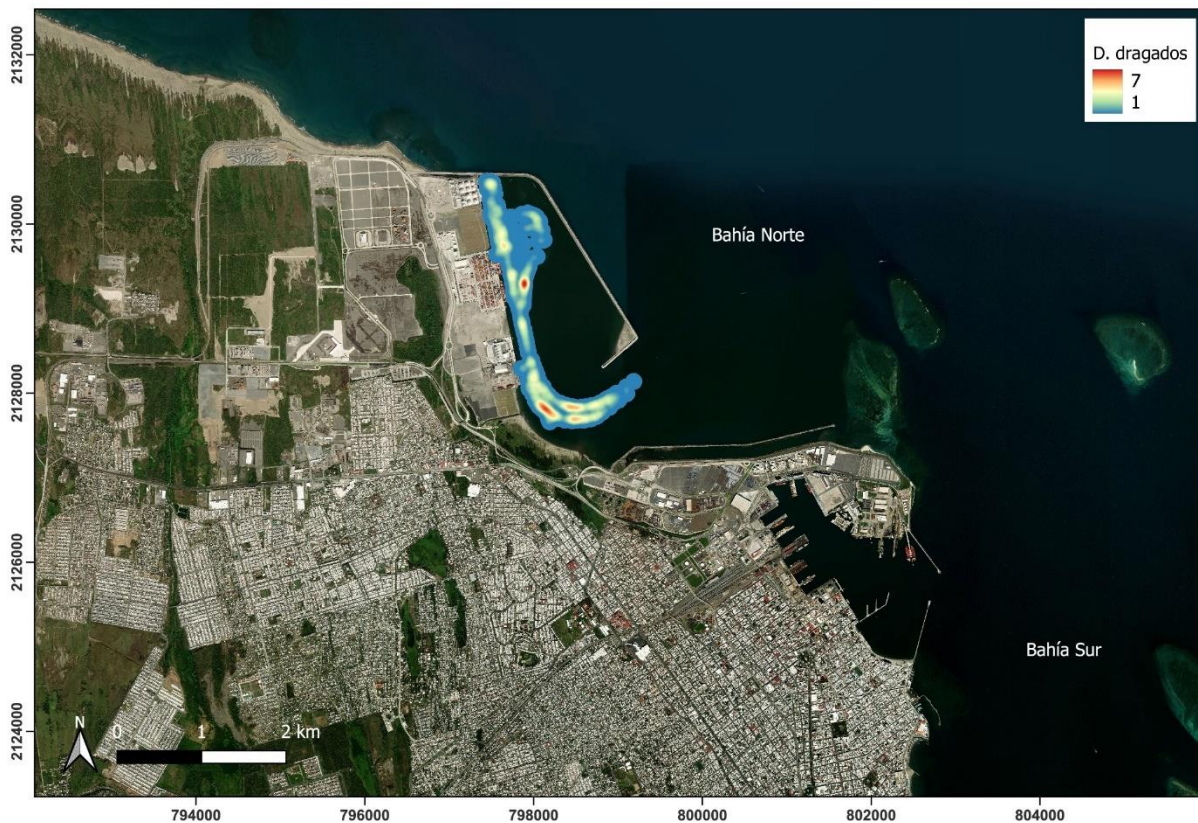
Figura 40. Mapa de actividad acumulada por dragado en la zona de ampliación
