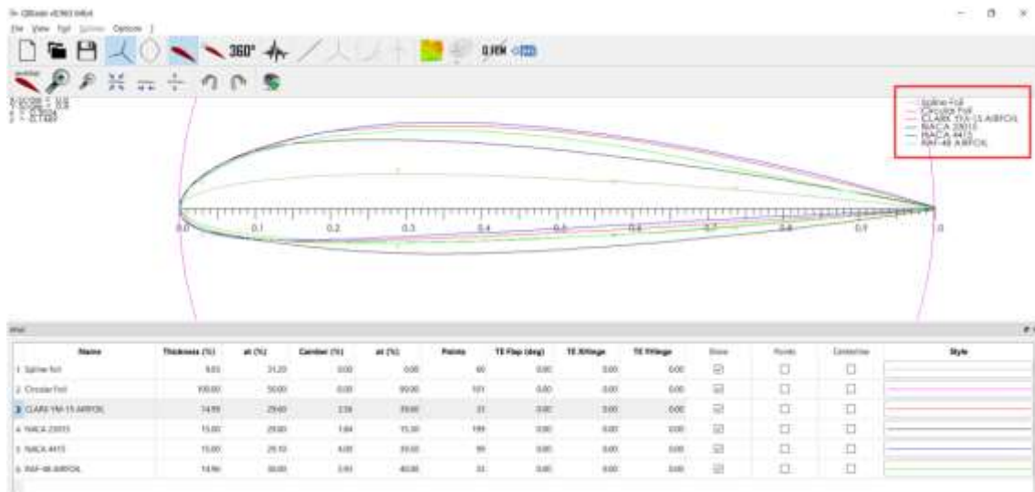
Figura 3.7.06 - Perfiles alares completos cargados en QBlade
