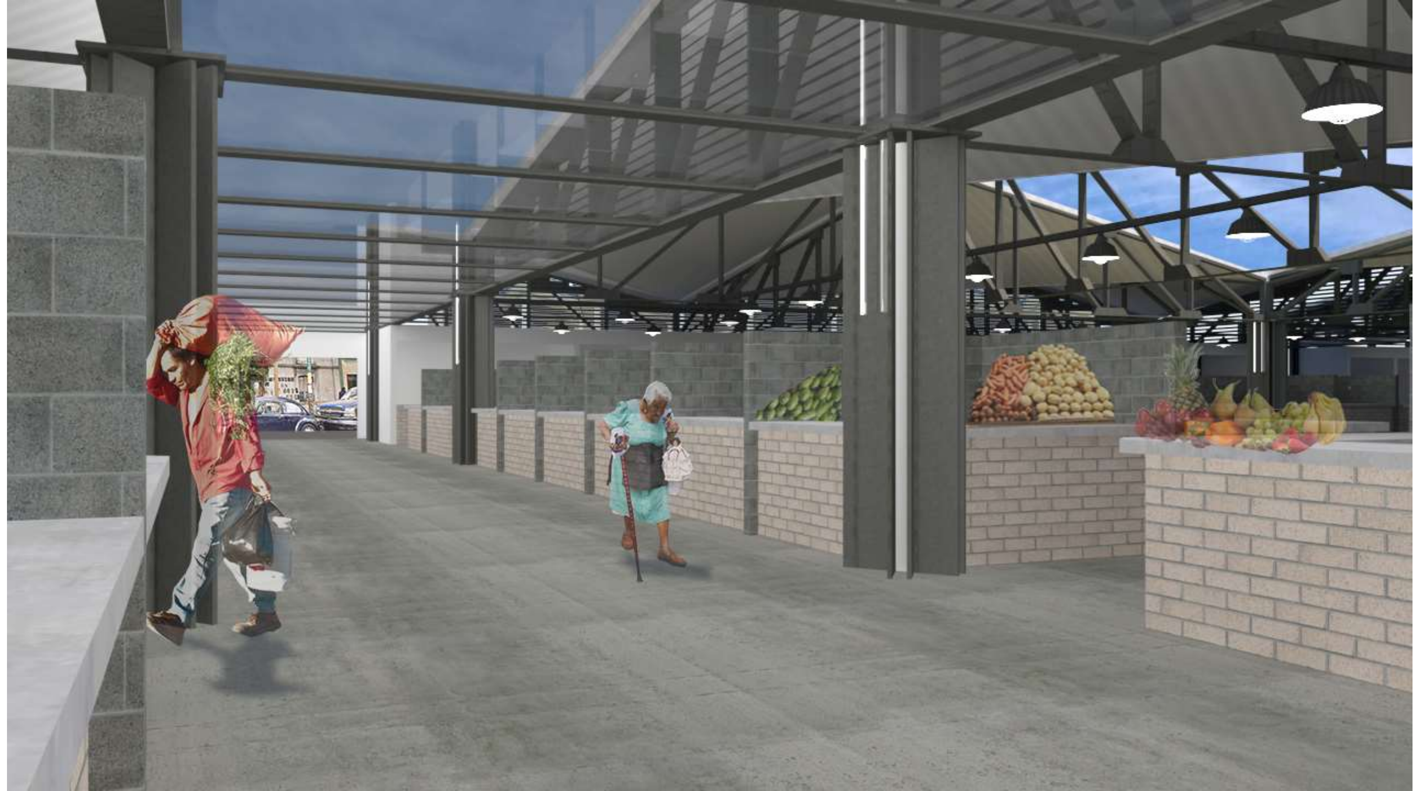
Gráfico 25. Render de la vista del pasillo central entre los ejes 5 y 6, separando la zona de venta húmeda y semihúmeda. Se puede observar el detalle de las columnas en forma de cruz con luminarias y tuberías de recolección de agua pluvial. También podemos observar la cubierta translúcida instalada sobre estos pasillos para proteger a los usuarios de la radiación solar y de lluvias. ELABORACIÓN PROPIA
