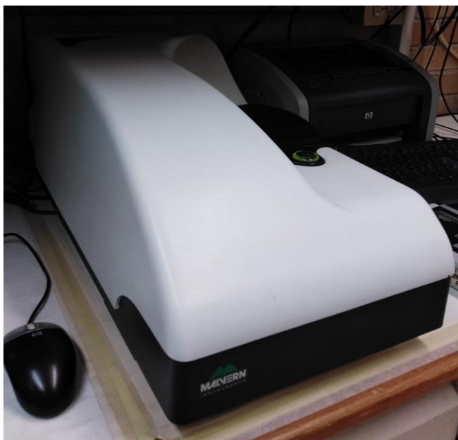
Figura 9. Nanoziser de Malvern Instruments; utilizado para medir conductividad y tamaño de partícula.
