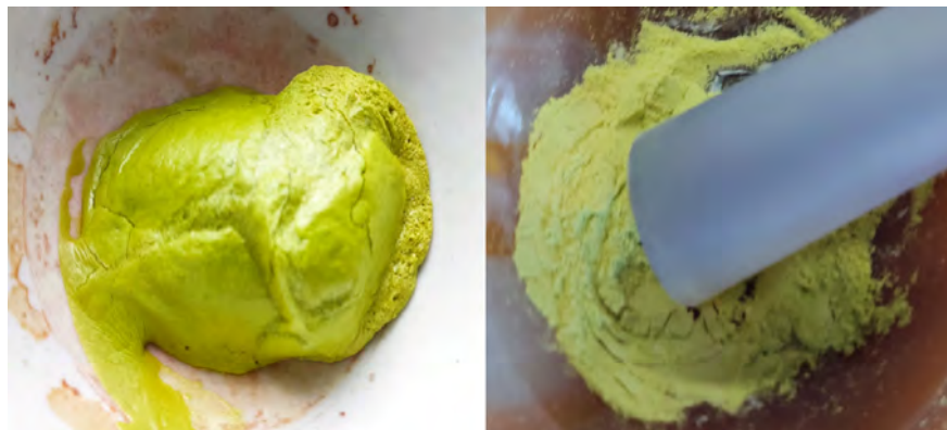
Figura 3.21. Gel seco (xerogel) para sintetizar Sr_2NiWO_6 en cápsulas de porcelana (izq.) y después de 30 min. de molienda de molienda en mortero de ágata (der.).
