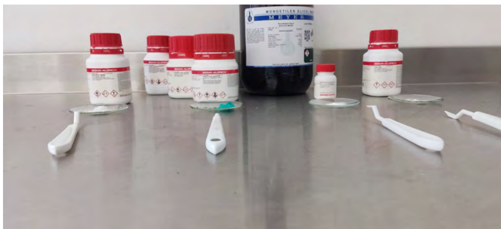
Figura 3.12. Reactivos pesados en cantidades estequiométricas y sus respectivos frascos (de izq. a der.) \text{Sr}(\text{NO}_3)_2 , \text{Ni}(\text{NO}_3)_2 \cdot 6\text{H}_2\text{O} , 5(\text{NH}_4)_2\text{O} \cdot 12\text{WO}_3 \cdot 5\text{H}_2\text{O} , \text{C}_6\text{H}_8\text{O}_7 , \text{C}_2\text{H}_6\text{O}_2 (frasco ámbar de vidrio).
