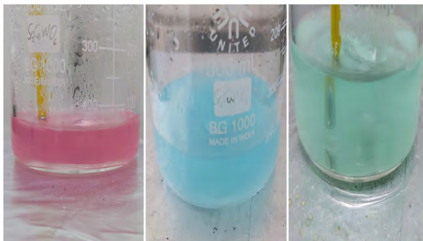
Figura 3.15. Soluciones (master solution) para sintetizar Sr_2XWO_6 con X = Co, Cu, Ni , respectivamente de izq. a der. con distintas perspectivas visuales.
