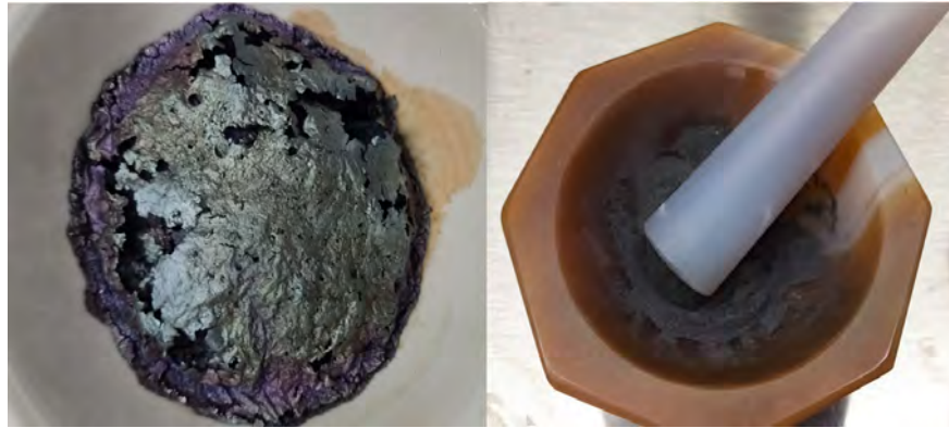
Figura 3.20. Gel seco (xerogel) para sintetizar Sr_2CuWO_6 en cápsulas de porcelana (izq.) y después de 30 min. de molienda de molienda en mortero de ágata (der.).
