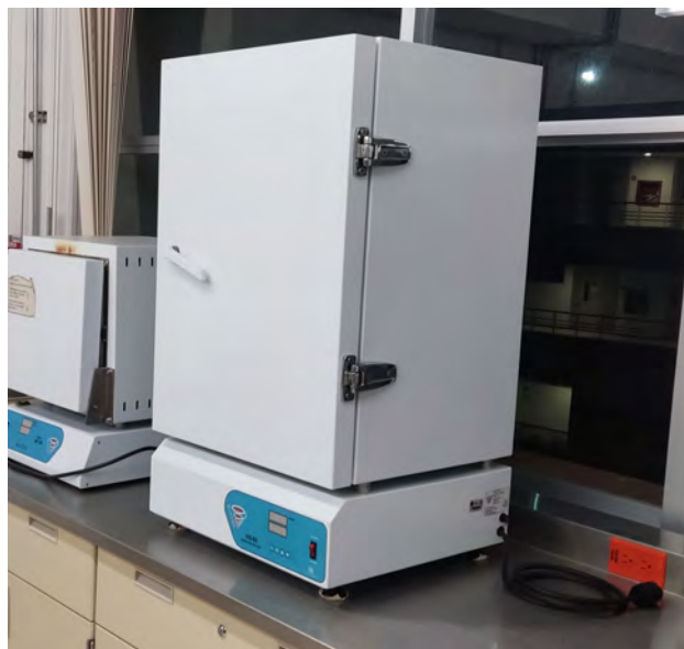
Figura 3.18. Horno de secado marca Prendo, modelo HS-60.
