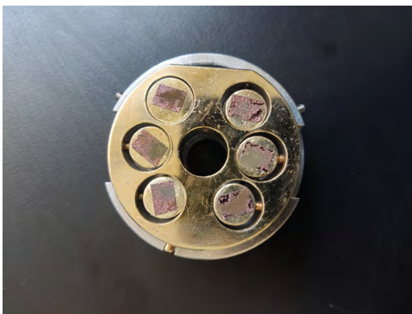
Figura 3.31. Portamuestras con los compuestos Sr_2XWO_6 ( X= Co, Cu, Ni ) recubierto por nanopartículas de oro.
