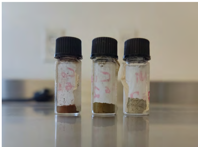
Figura 3.25. Viales con muestras tamizadas de los compuestos de interés: \text{Sr}_2\text{XWO}_6 ( X=\text{Co}, \text{Cu}, \text{Ni} ) (izq. a der.) vía sol-gel.
