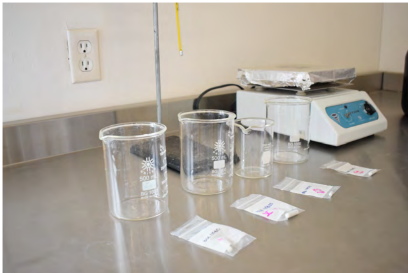
Figura 3.11. Vasos de precipitados y agitadores etiquetados para su uso exclusivo en sus respectivas soluciones (créditos de fotografía YAL).
