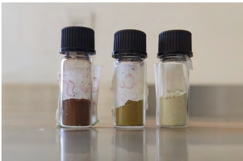
Figura 3.7. Viales con muestras tamizadas de los compuestos de interés: Sr_2XWO_6 ( X=Co, Cu, Ni ) (izq. a der.).
