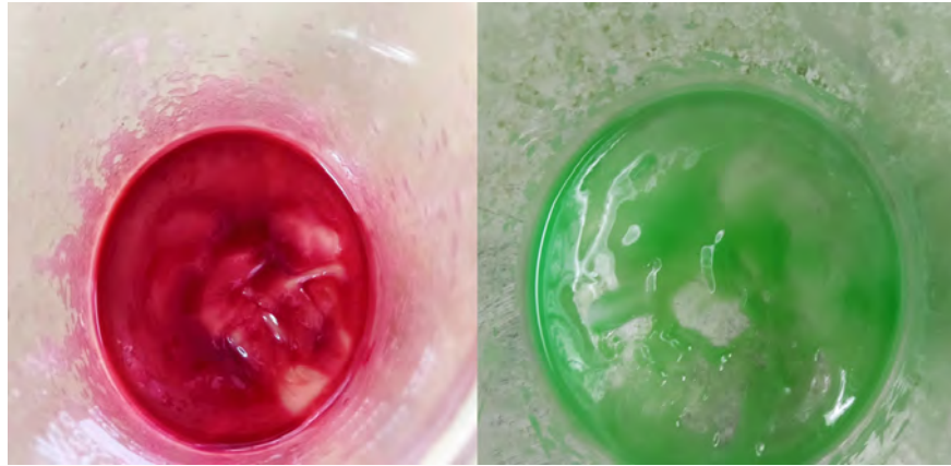
Figura 3.16. Gel para sintetizar \text{Sr}_2\text{CoWO}_6 y \text{Sr}_2\text{NiWO}_6 respectivamente en los vasos de precipitados.
