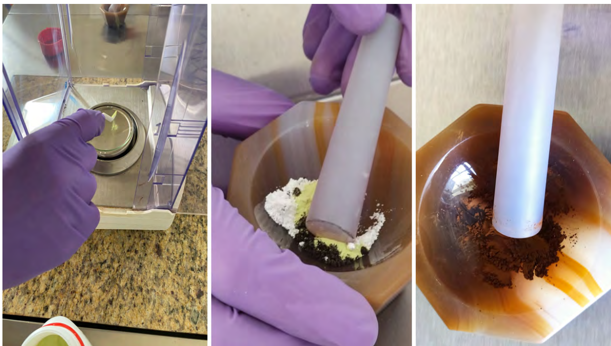
Figura 3.3. Pesaje en balanza analítica (el reactivo pesado en la imagen es WO 3 ); reactivos colocados en mortero de ágata, listos para iniciar las moliendas; y la muestra al final de la molienda (de izq. a der.).
