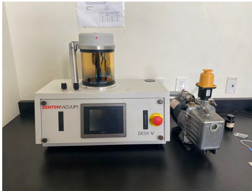
Figura 3.32. Recubridor por pulverización catódica [86] del laboratorio de microscopia de la ENES UNAM Unidad Morelia. [85]
