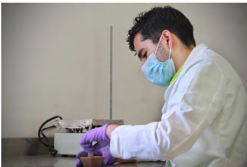
Figura 3.5. Molienda en mortero de ágata para reacción de estado sólido (créditos de fotografía para la Lic. en CMS Alejandra Ramos Vences).
