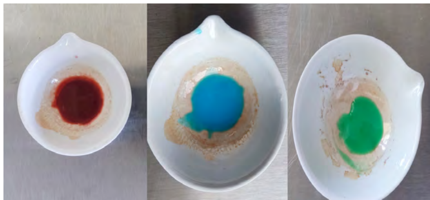
Figura 3.17. Gel para sintetizar \text{Sr}_2\text{CoWO}_6 , \text{Sr}_2\text{CuWO}_6 y \text{Sr}_2\text{NiWO}_6 respectivamente en cápsulas de porcelana.
