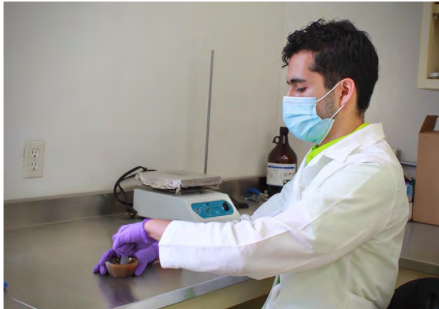
Figura 3.24. Molienda mecánica en mortero de ágata (créditos para la Lic. en CMS Alejandra Ramos Vences).
