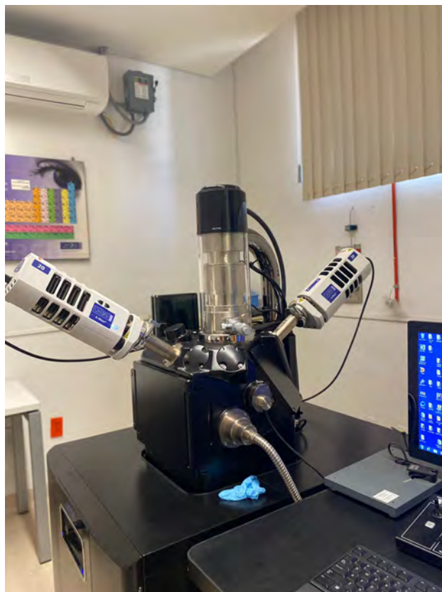
Figura 3.36. Doble detector EDS a 35^\circ opuestos entre sí a 180^\circ para análisis EDS del laboratorio de Microscopía de la ENES Campus Morelia [85].
