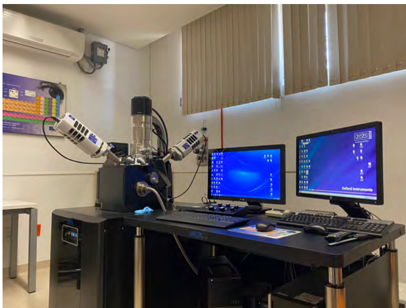
Figura 3.34. Microscopio electrónico de barrido JEOL JSM-IT300[87]. Actualmente se encuentra en operación del laboratorio de Microscopía de la ENES Campus Morelia [85].
