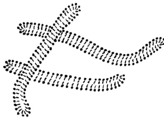
**Figura 1.1.** Esquema idealizado de un fluido micelar de tipo gusano (Yang, 2002)
