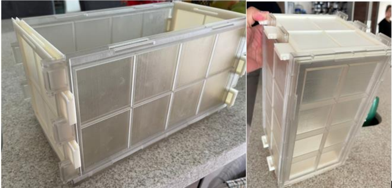
ILUSTRACIÓN 105 IMPRESIÓN 3D A TAMAÑO REAL DE CONTENEDOR
