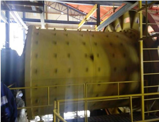
Se utilizan 3 y hasta 5 molinos de bolas en circuitos diferentes para prevenir paros por mantenimiento, aumento o disminución de la producción.
