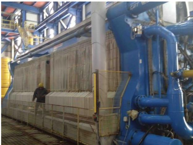
Luego la pulpa pasa a filtros prensa donde se elimina la mayor parte de lodos y se obtiene la solución rica.
