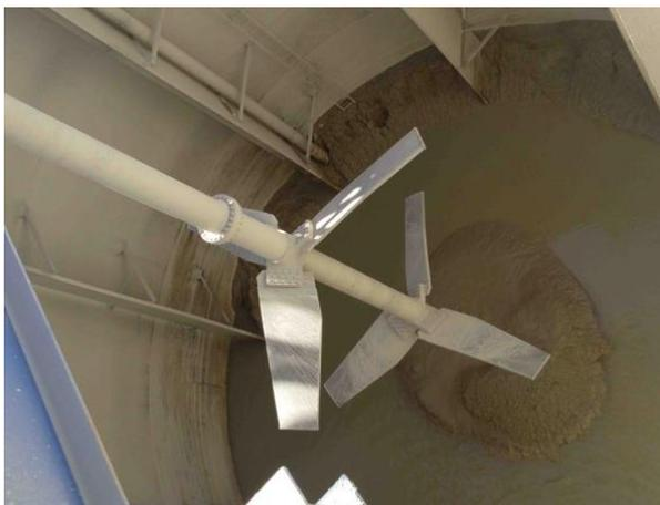
Detalle de los agitadores dentro de un tanque de agitación. La agitación permite oxigenar la pulpa para que el oxígeno acelere el proceso.
